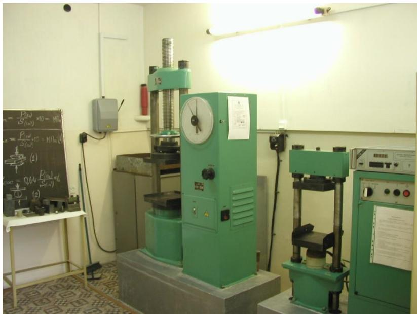
Рис. 1 Прессы в лаборатории физико-механических свойств горных пород
