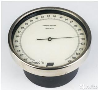
Рис. 3.1 Барометр-анероид «БААМ-1»
