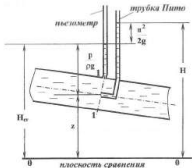
Рис. 1.1. Экспериментальное определение статического, полного и скоростного напоров
