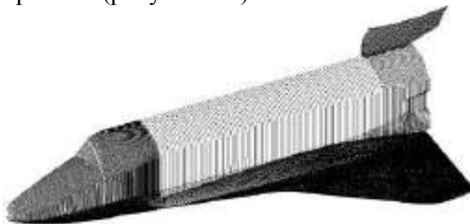
Рисунок 2.2 - Каркасная модель теоретических обводов космического корабля Буран
