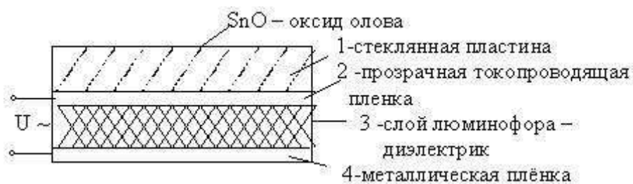
Рис. 6.2. Структура электролюминесцентного индикатора:
