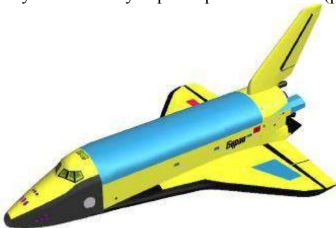
Рисунок 2.3 - Поверхностная модель теоретических обводов космического корабля Буран
