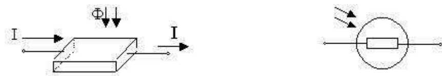
Рис. 5.3. Конструктивное представление и УГО фоторезистора
