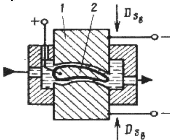
Рис. 8.7. Схема электрохимической размерной обработки:
