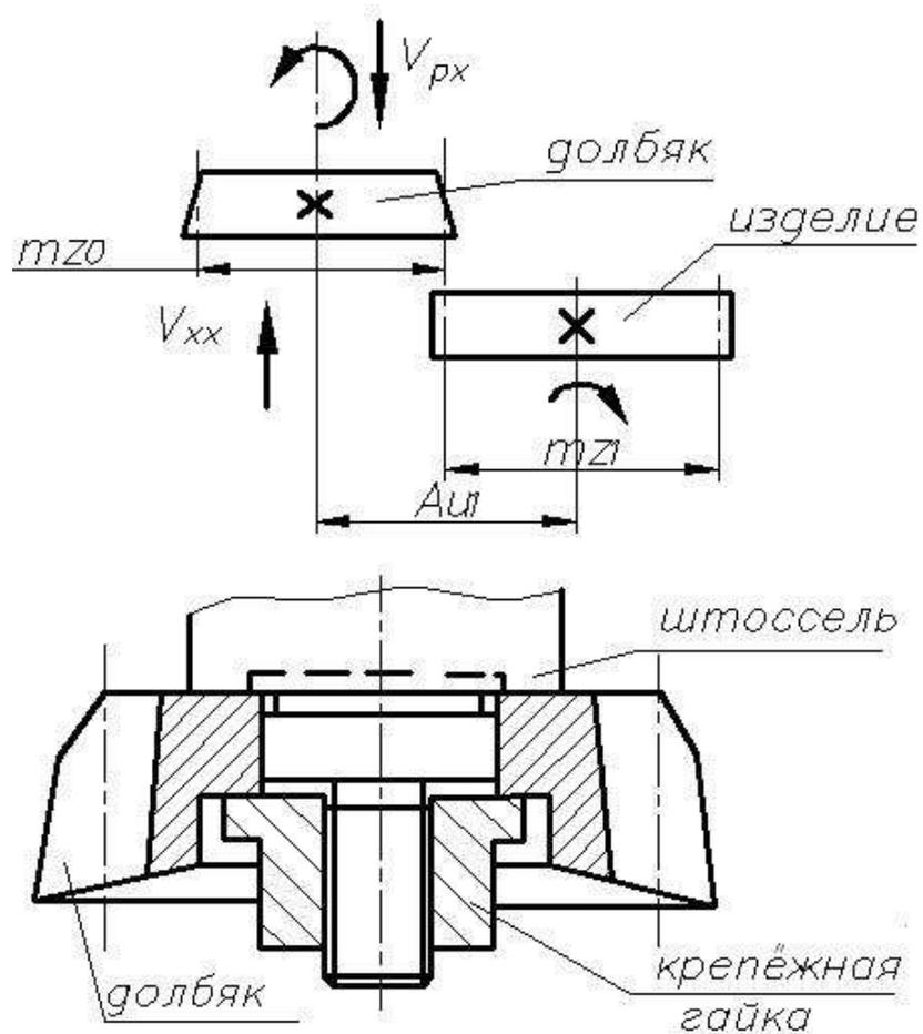
Рис . 9.1. Схема работы и крепления зуборезного долбьяка
