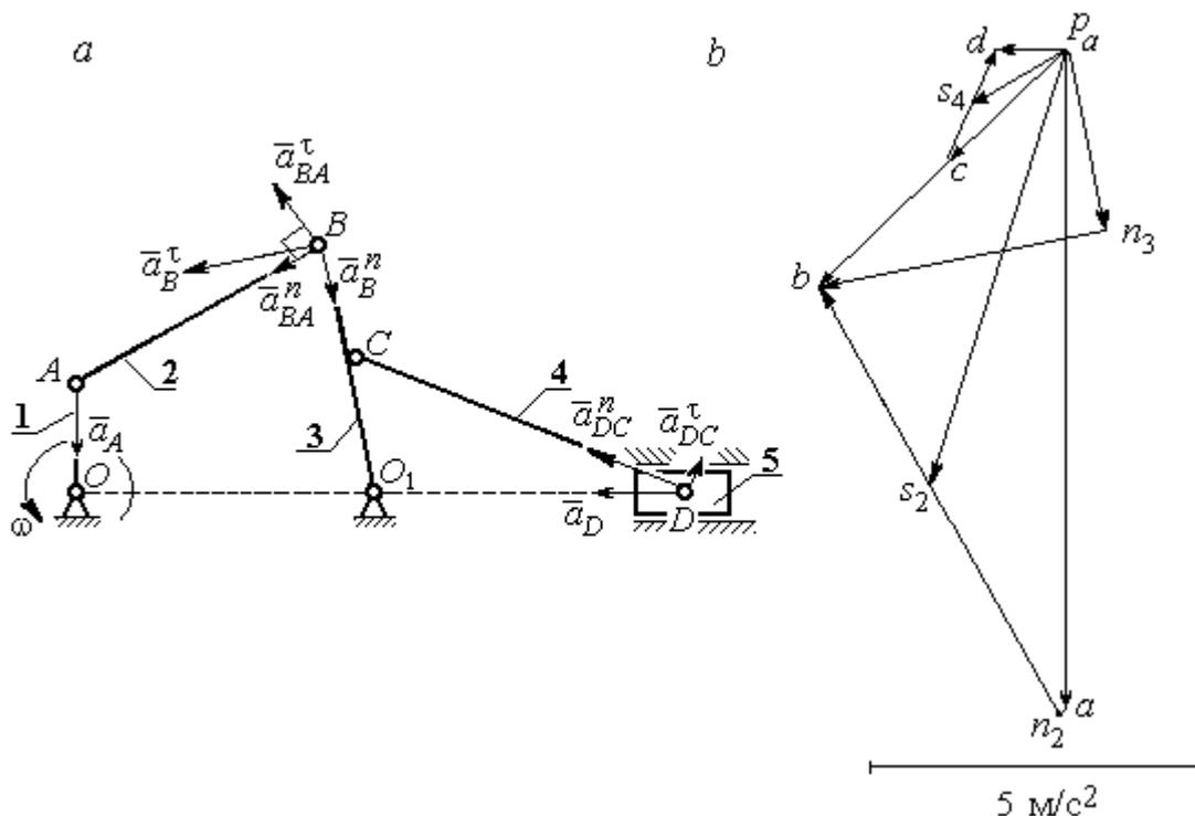
Рис. 3.6. План ускорений механизма:
