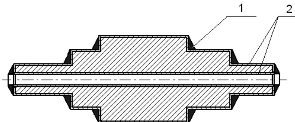
Рис. 6.12. Припуски на механическую обработку и усадку
