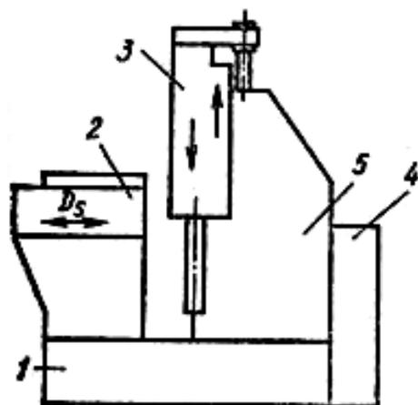
Рис. 6.12. Вертикально-протяжной станок:
