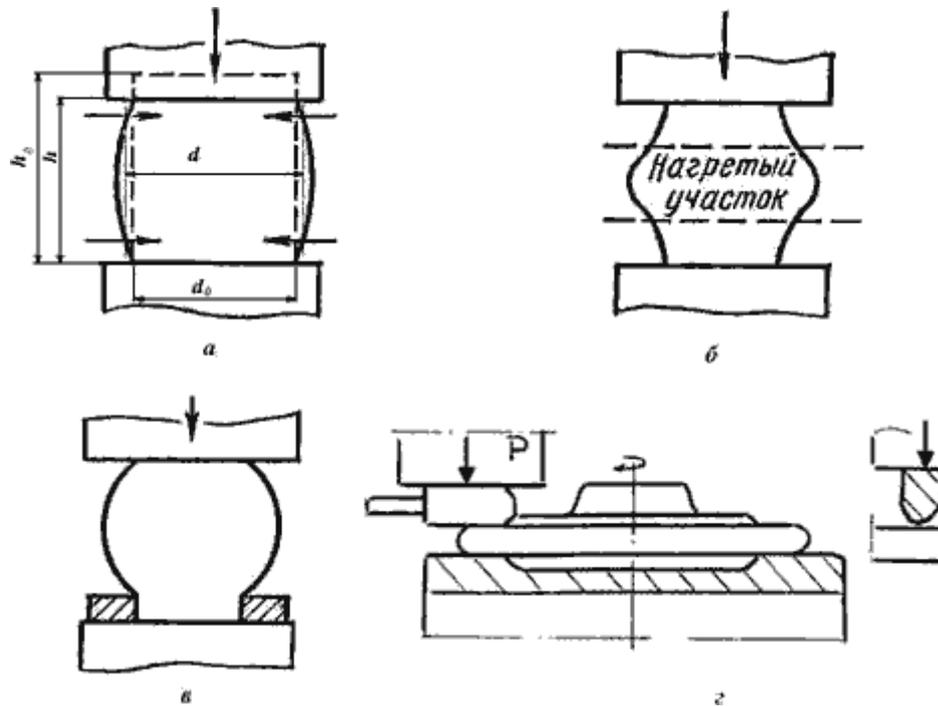
Рис.12.2. Схемы осадки и ее разновидностей
