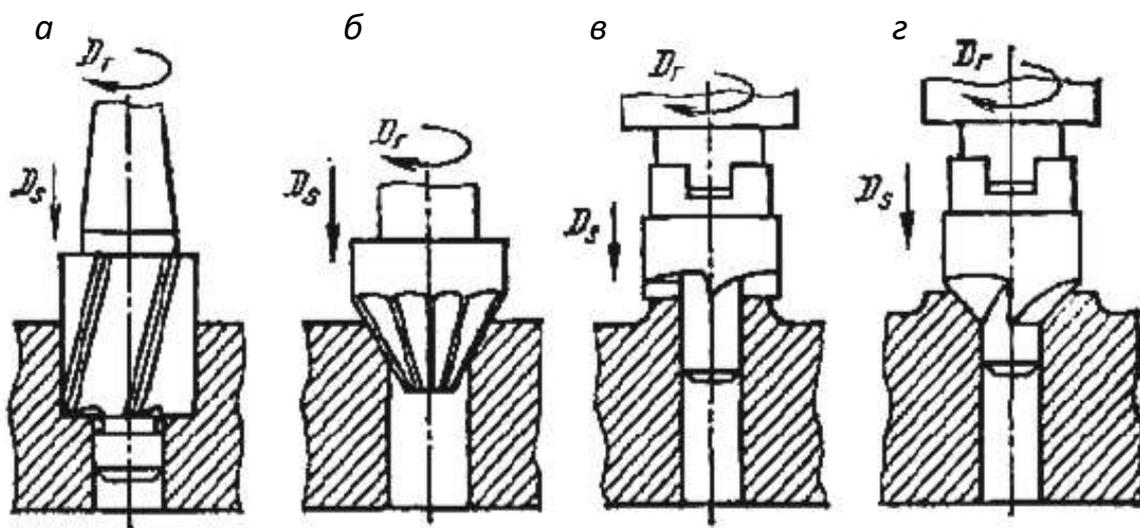
Рис. 4.2. Схемы обработки углублений и бобышек зенкерами:
