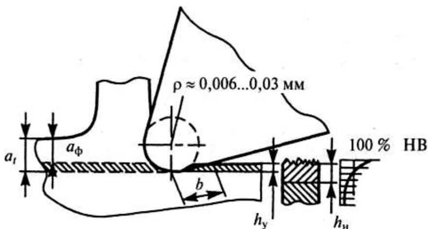
Рис. 1.12. Образование наклепа
