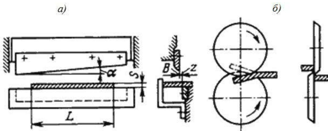
Рис. 3.5. Схемы действия ножниц
