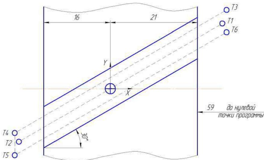
Рис. 10 - Траектории движения инструментов в плоскости основания паза
