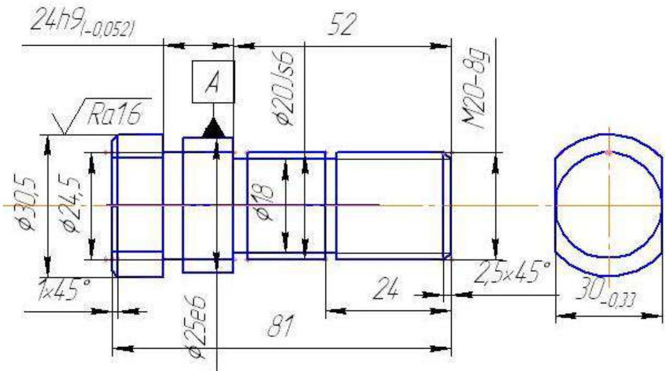
Рис. 1. Чертеж оси
