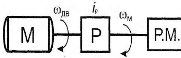
Рисунок 4.2 – Кинематическая схема системы «электродвигатель-рабочая машина»
