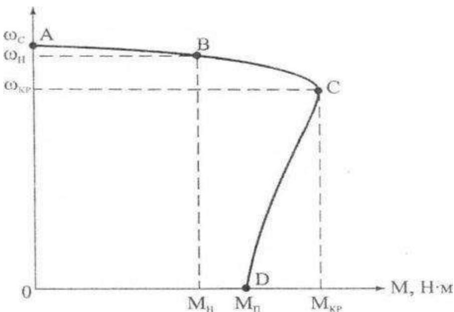
**Точка С** ( $M = M_{кр}$ ;  $\omega = \omega_{кр}$ );  $M_{кр}$  - момент критический (или максимальный), Н·м;  $\omega_{кр}$  - критическая скорость вращения, рад/с.
