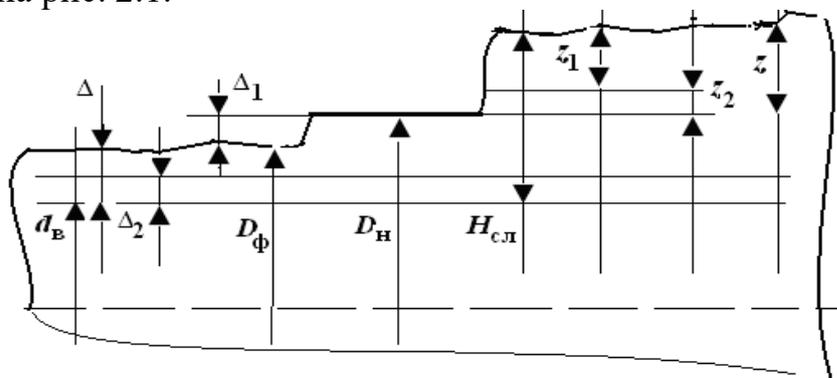
Рис. 2.1. Схема расчета наносимого слоя при восстановлении поверхности:  $H_{сл}$  – толщина слоя наносимого материала;  $\Delta$  – толщина снимаемого слоя;  $\Delta_1$  – величина износа;  $\Delta_2$  – толщина дефектного слоя материала;  $z$  – припуск на механическую обработку,  $z_1$  – припуск на черновую обработку,  $z_2$  – припуск на чистовую обработку,  $d_в$  – диаметр поверхности, подготовленной к восстановлению,  $D_H$  – номинальный размер,  $D_ф$  – фактический размер
