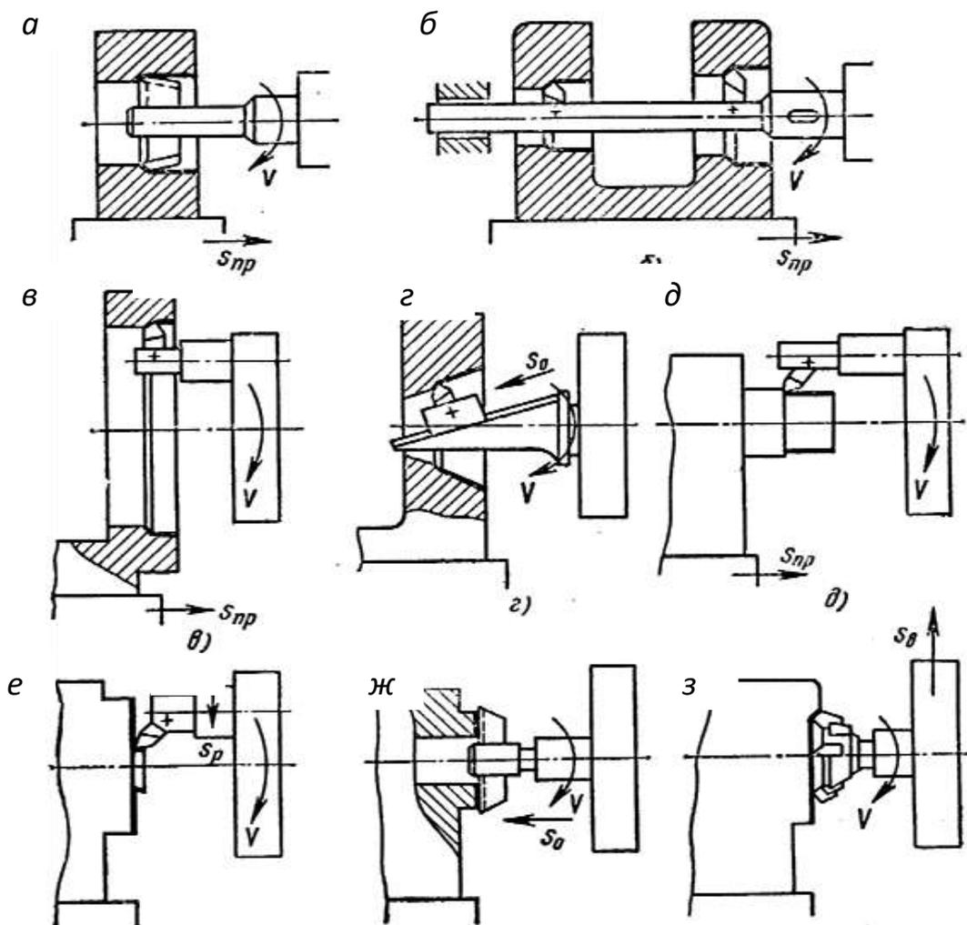
Рис. 4.13. Схемы обработки поверхностей на горизонтально-расточных станках
