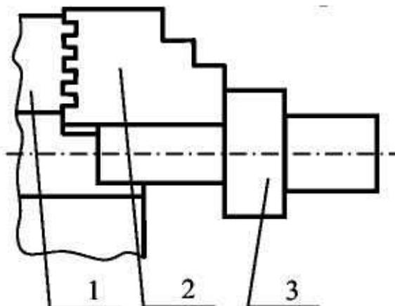
Рис. 38. Схема установки заготовки в трехкулачковом патроне
