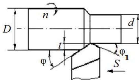
Рис. 1.2. Схема обработки заготовки при определении продольной шероховатости
