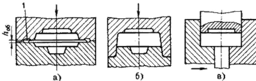
Рис. 13.2. Схемы штамповки в открытых и закрытых штампах:
