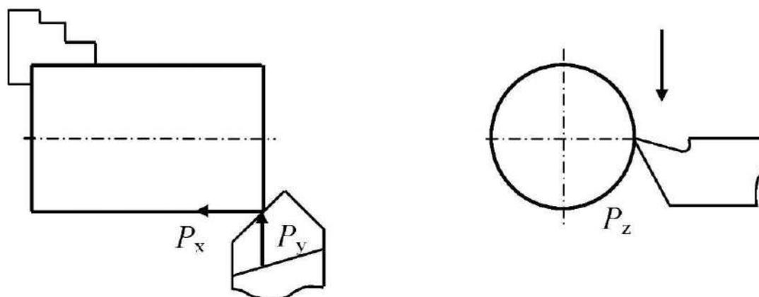
Рис. 2.1. Схемы сил резания, действующих при обработке вала на токарном станке
