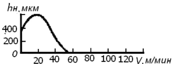
Рис. 1.14. Зависимость величины нароста от скорости резания для стали 40Х
