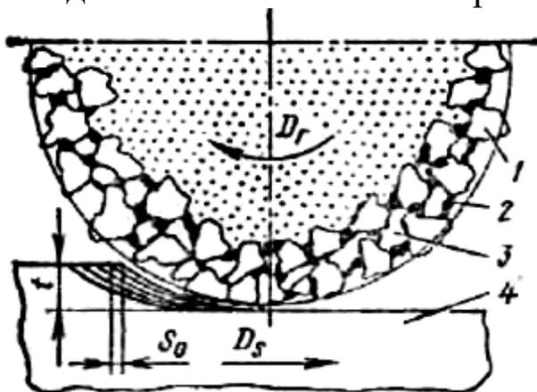
Рис. 7.1. Схема срезания припуска при шлифовании и конструктивные особенности абразивного инструмента:
