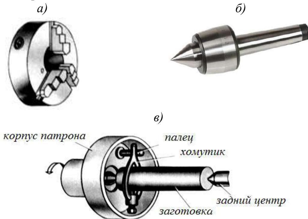
Рис. 1.3. Приспособления к токарным станкам:
