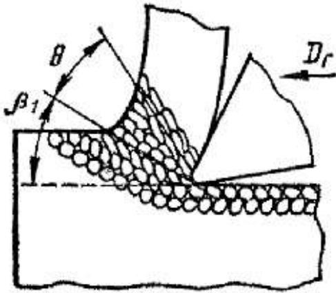
Рис. 1.8. Схема пластически деформированной зоны при резании
