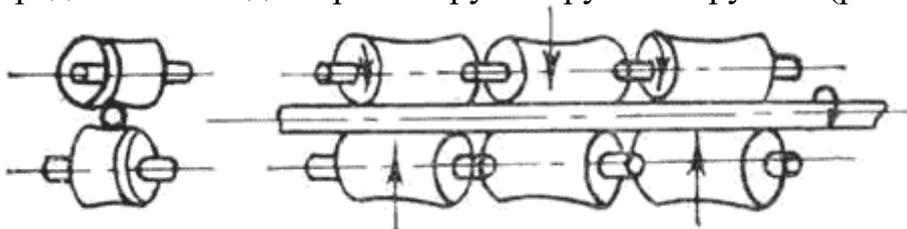
Рис. 10.7. Схема правки проката на машинах с косо расположенными гиперболическими роликами
