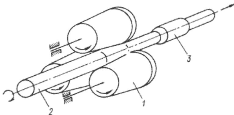
Рис. 11.3. Схема прокатки на трехвалковом стане
