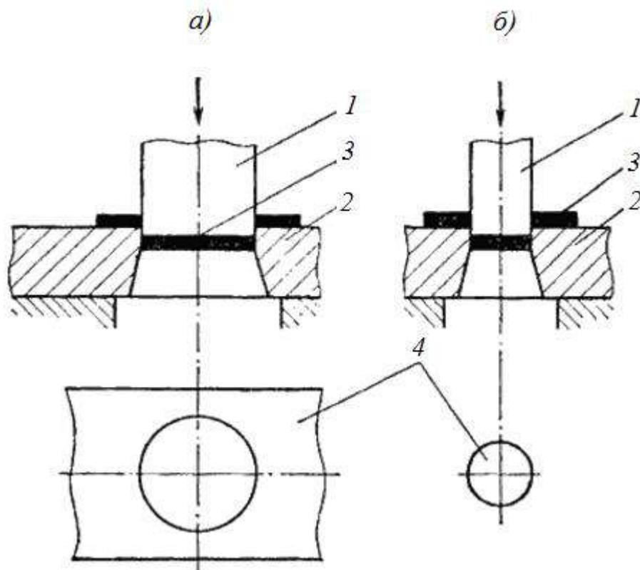
Рис. 3.6. Схема процессов вырубке (а) и пробивке (б)
