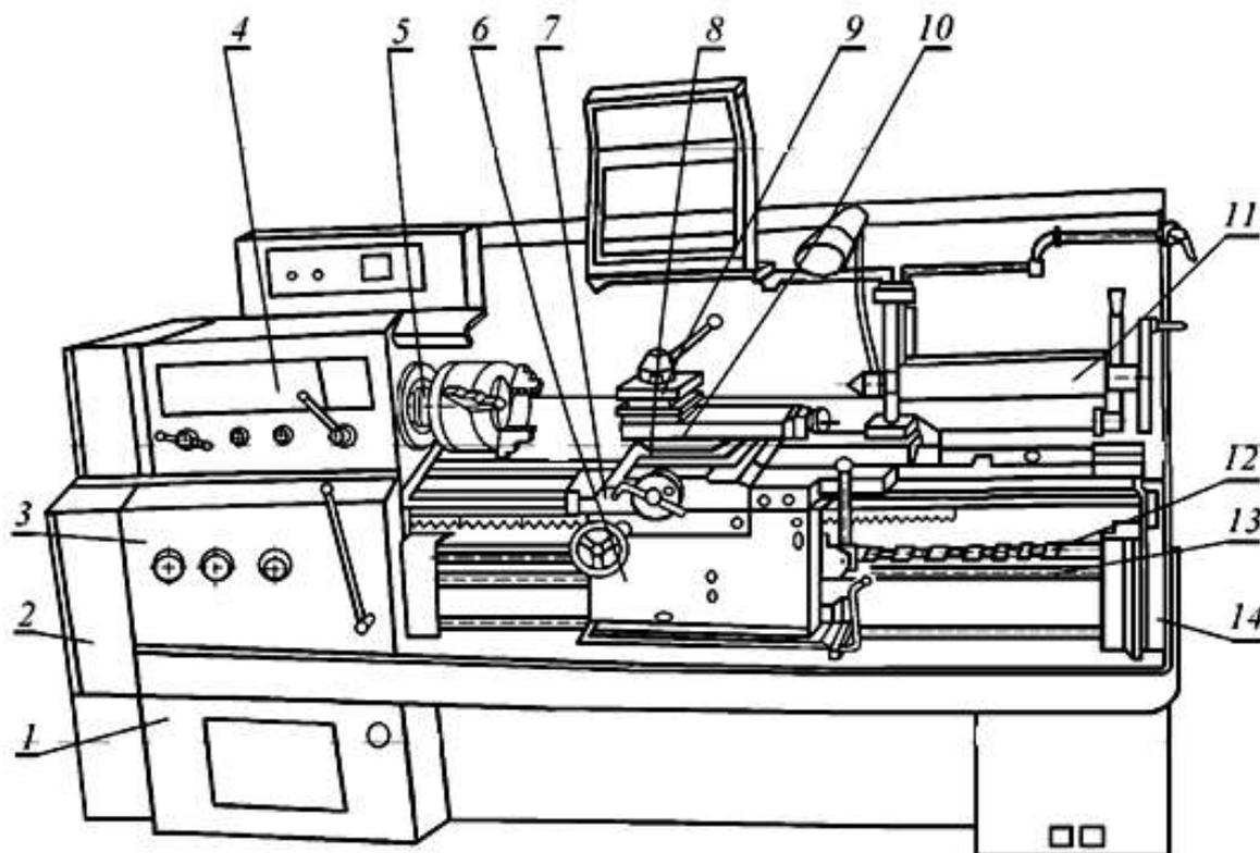
Рис. 1.1. Общий вид токарно-винторезного станка модели 16К20
