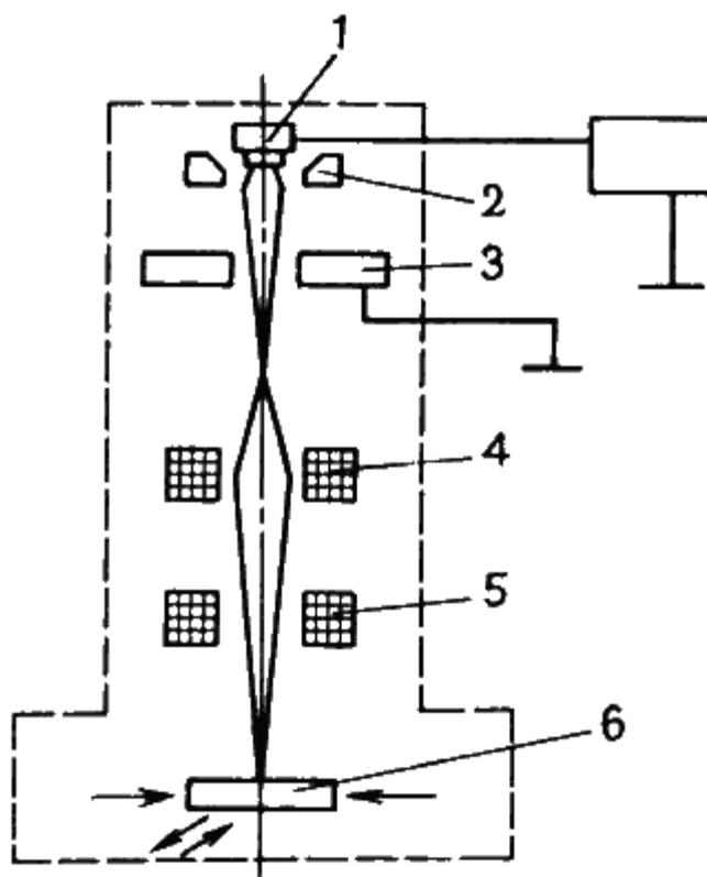
Рис.17.5. Схема установки для электронно-лучевой сварки
