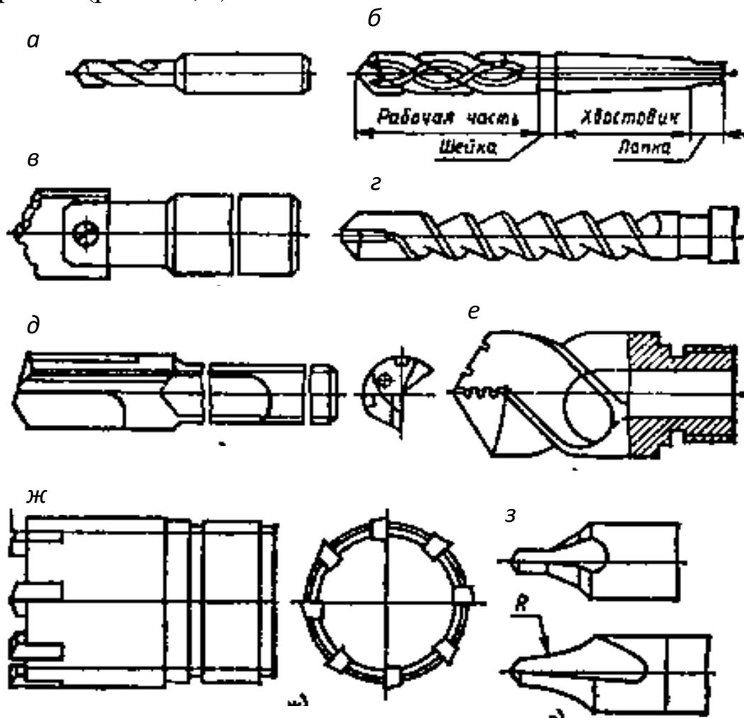
Рис. 4.3. Конструкции сверл:
