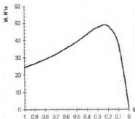
Рисунок 1.4 Естественная механическая характеристика асинхронного электродвигателя с к.з. ротором
