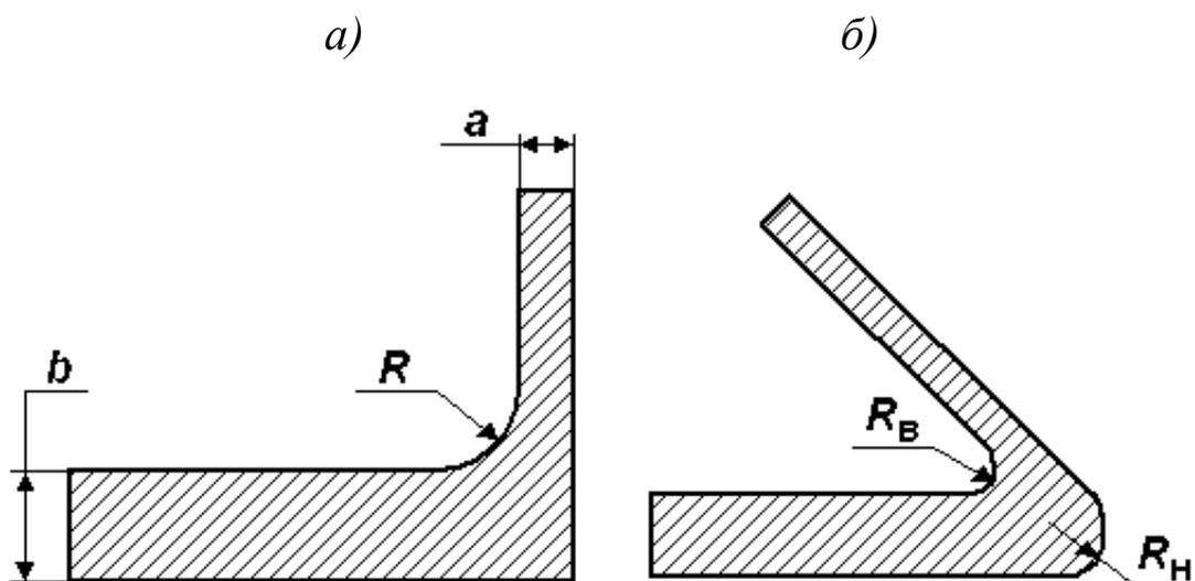
Рис. 6.6. Галтели при сопряжении стенок разной толщины
