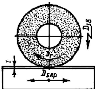
Рис. 7.3. Схема обработки заготовки на плоскошлифовальном станке периферией круга
