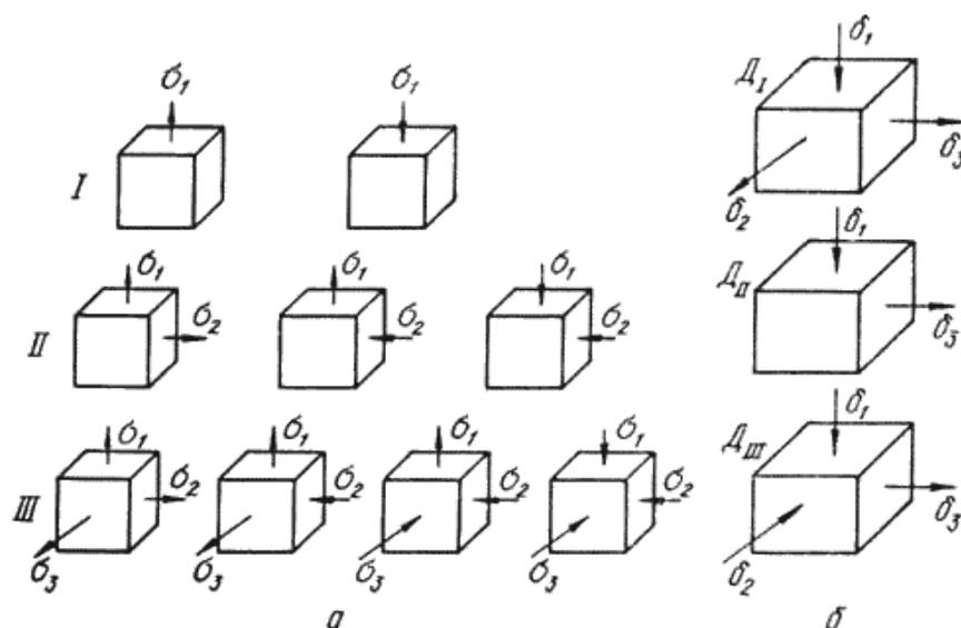
Рис. 9.1. Схемы напряженного (а) и деформированного (б) состояний:
