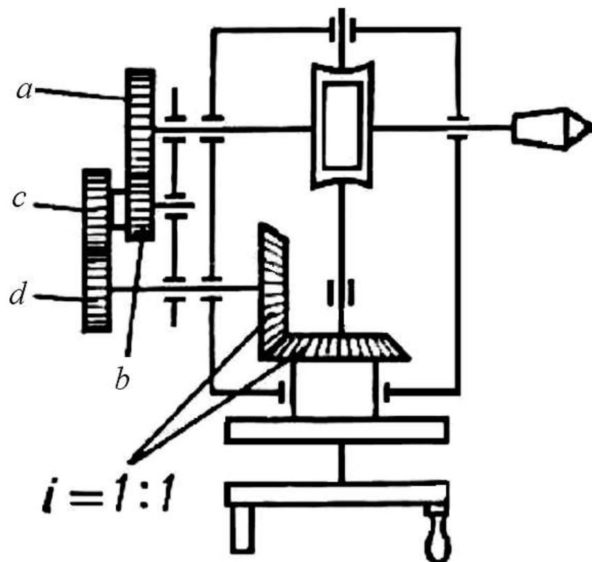
Рис. 10. Кинематическая схема УДГ, настроенной на дифференциальное деление.
