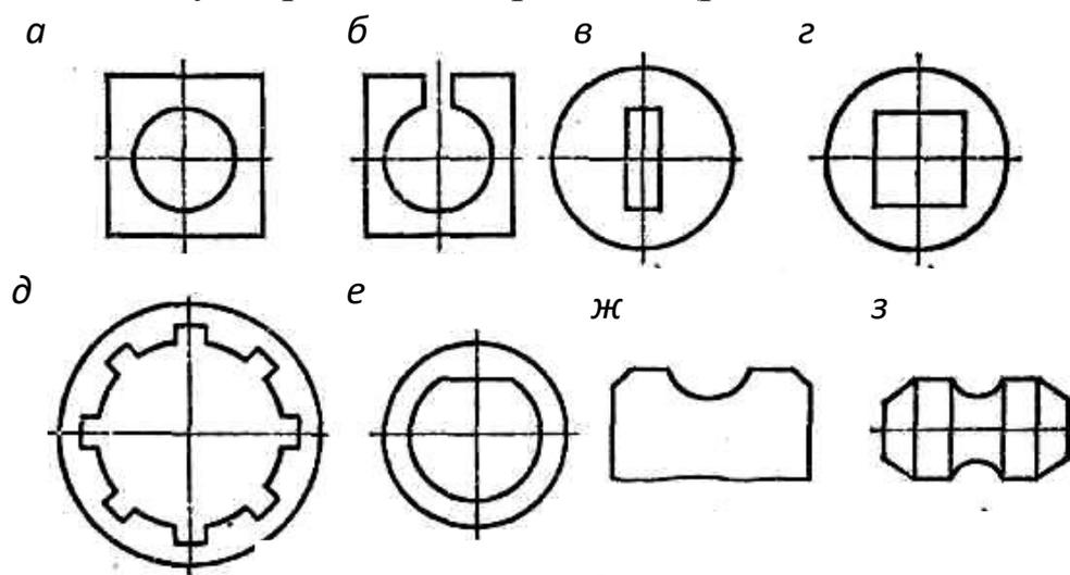
Рис. 6.6. Основные виды обрабатываемых поверхностей при протягивании:
