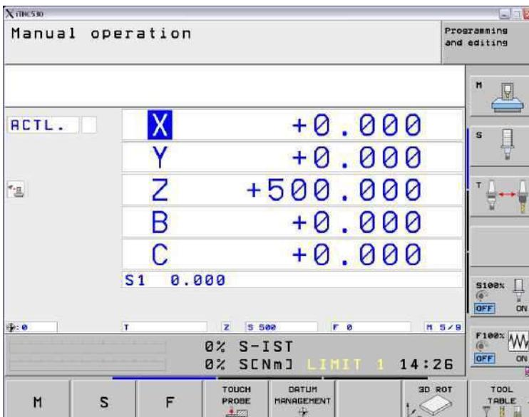
Рис. 8 - Интерфейс системы ЧПУ iTNC 530
