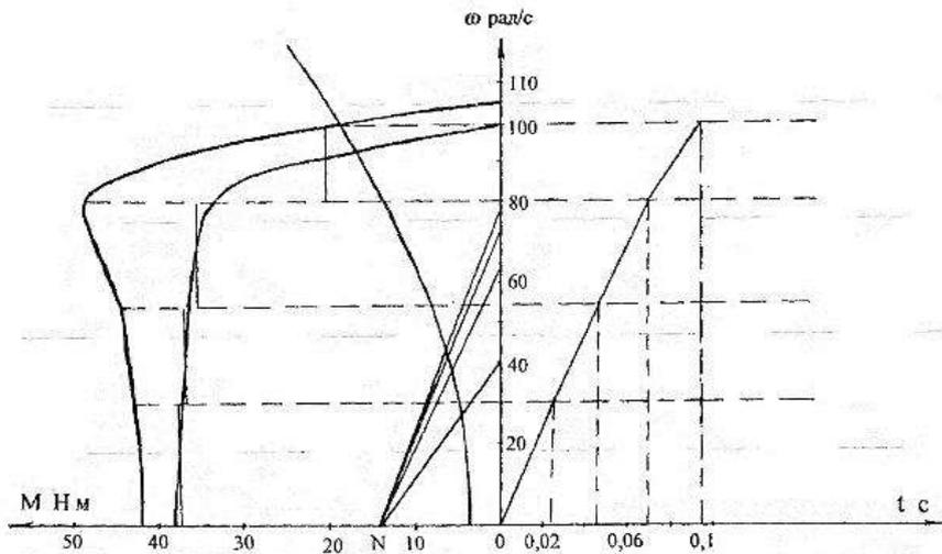
Рисунок 4.6 - Определение времени пуска системы «Электродвигатель типа АИР 100L6 – вентилятор» графоаналитическим методом
