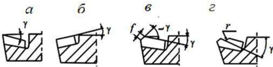
Рис. 2.11. Формы передней поверхности резцов:
