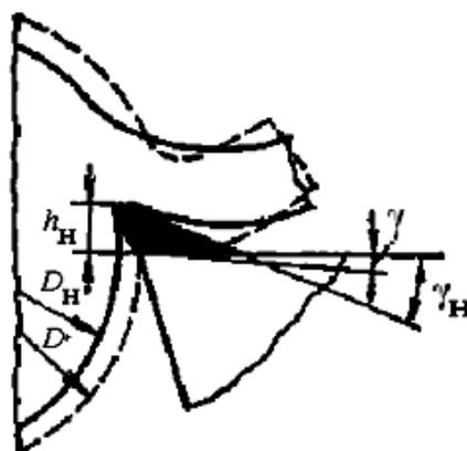
Образование нароста явление нестабильное. В процессе обработки нарост, постепенно формируясь, достигает максимального значения. Затем за счет сил трения он может быть унесен со стружкой или вдавлен в обработанную поверхность. Нестабильность нароста
