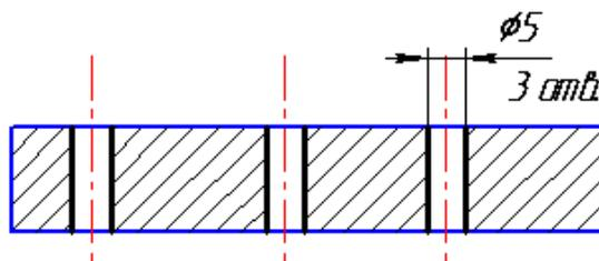
Рис. 4. Схема одного перехода (сверление нескольких одинаковых отверстий)
