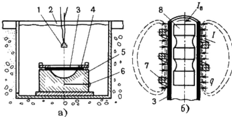
Рис. 16.3. а- электрогидравлическая, б – электромагнитная штамповка
