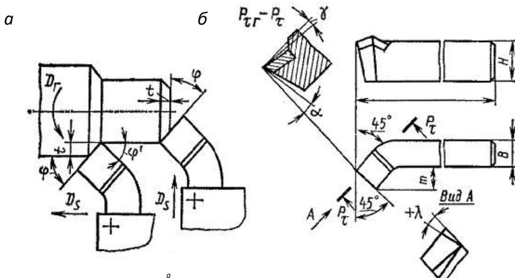
Рис. 3.2. Наружное точение проходным отогнутым резцом:
