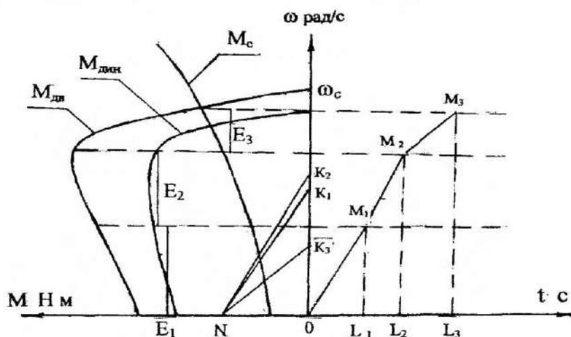
Рисунок 4.5 -Графоаналитический метод определения времени пуска системы «электродвигатель – вентилятор» до установившейся скорости вращения
