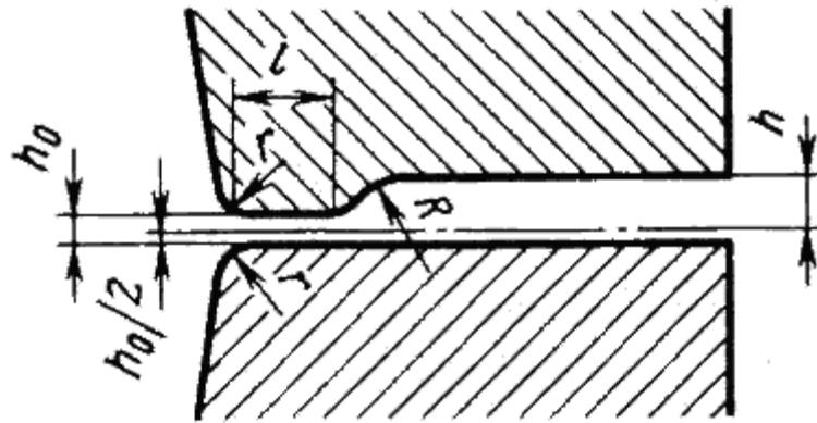
Рис.14.3. Вид облойной канавки при штамповке на прессах
