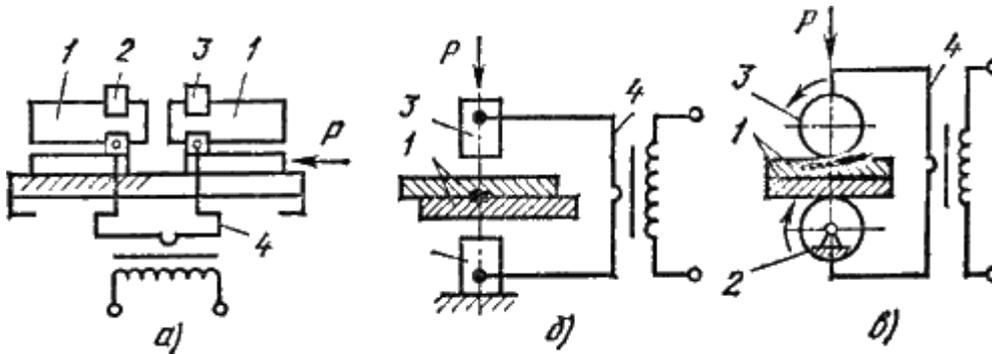
Рис. 18.1. Схемы контактной сварки:
