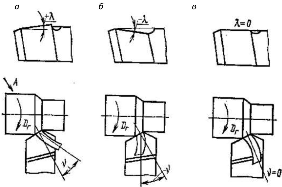
Рис. 1.6. Углы наклона главной режущей кромки:
