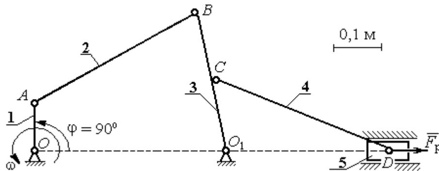
Рис. 3.4. План механизма насоса в масштабе 1:4
