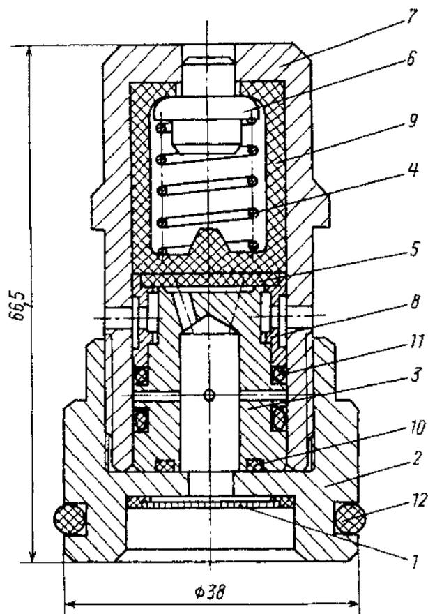
Рис. 31. Гидроклапан предохранительный
