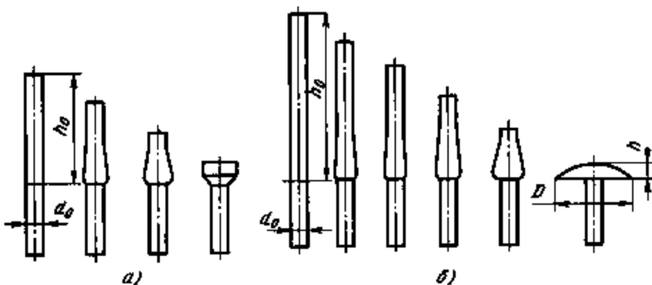
Рис. 3.2. Последовательность изготовления детали:
