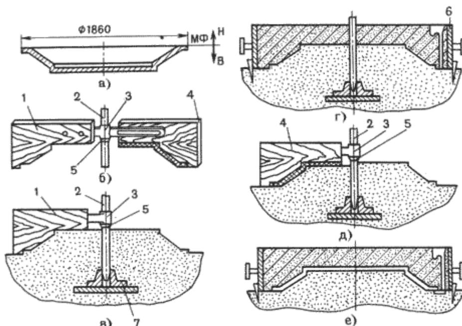
Рис.5.4. Шаблонная формовка
