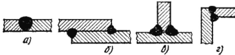
Рис.18.2. Основные типы сварных соединений
