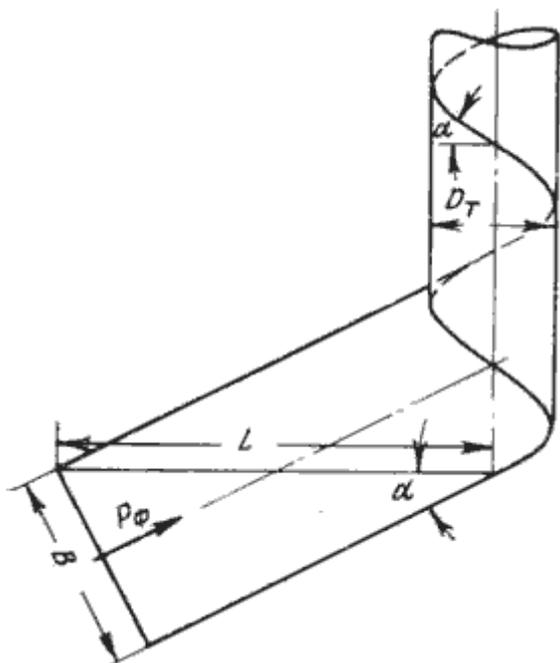
Рис.11.2. Схема формовки заготовки при спиральной сварке трубы
