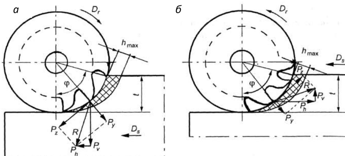
Рис. 5.1 Схемы фрезерования (цилиндрическое фрезерование):
