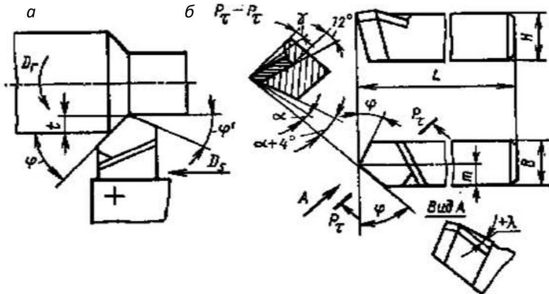
Рис. 3.1. Наружное точение прямым проходным резцом:
