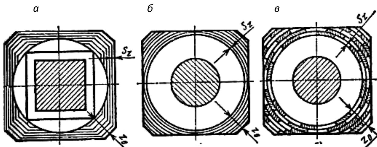
Рис. 6.8. Схемы резания при протягивании:
