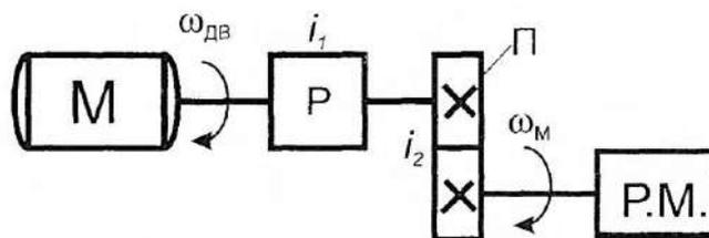
М – электродвигатель; Р – редуктор; П- клиноремённая передача; Р.М, - рабочая машины;  $i_1$ - передаточное отношение редуктора;  $i_2$ - передаточное отношение клиноремённой передачи;  $\omega_{дв}$ - угловая скорость вращения вала электродвигателя;  $\omega_{м}$  –угловая скорость вращения вала рабочей машины.
