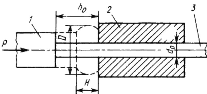
Рис.15.1. Схема высадки
