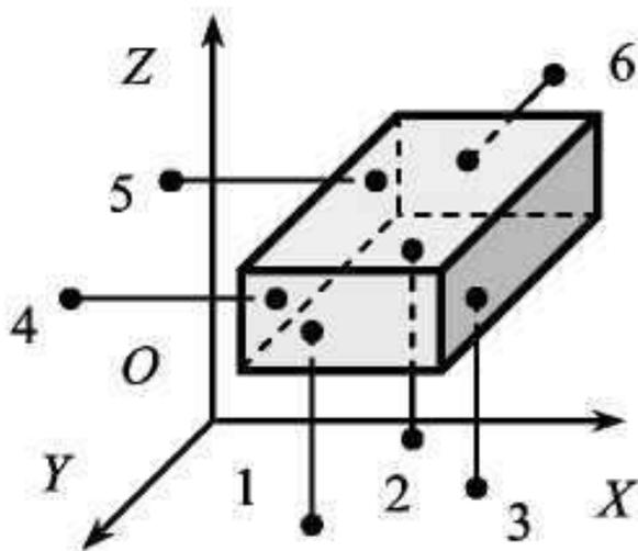
Рис. 17. Схема базирования призматического тела
