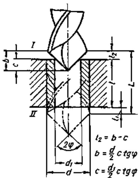
Рис. 4.8. Расчетная длина хода сверла:
