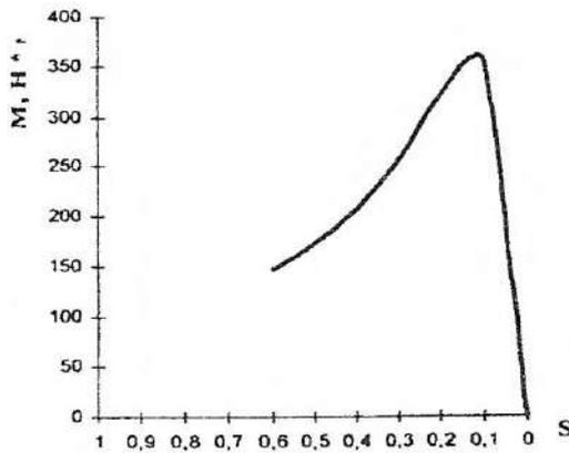
Рисунок 2.2 Естественная механическая характеристика асинхронного электродвигателя с фазным ротором
