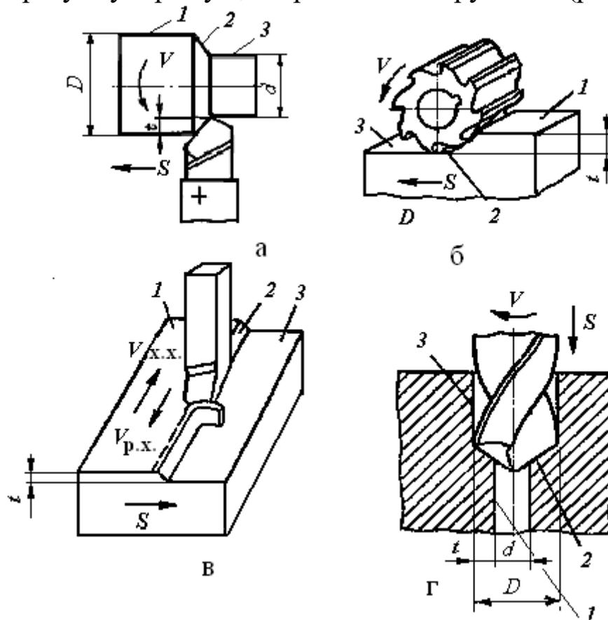
Рис. 3.1 Схемы обработки заготовок:
