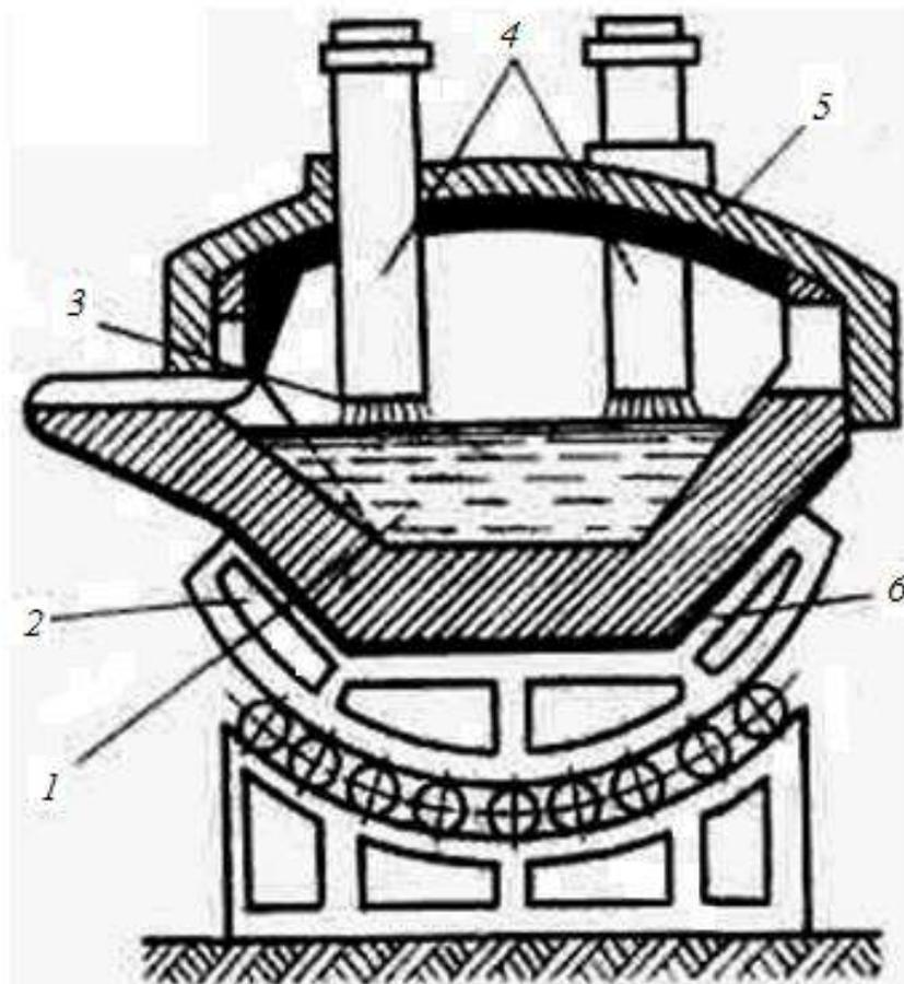
Рис. 2.1. Дуговая электропечь с вертикально расположенными электродами
