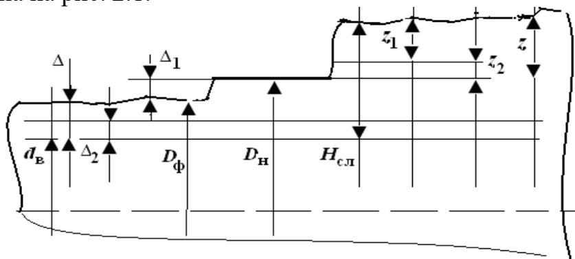
Рис. 2.1. Схема расчета наносимого слоя при восстановлении поверхности:
