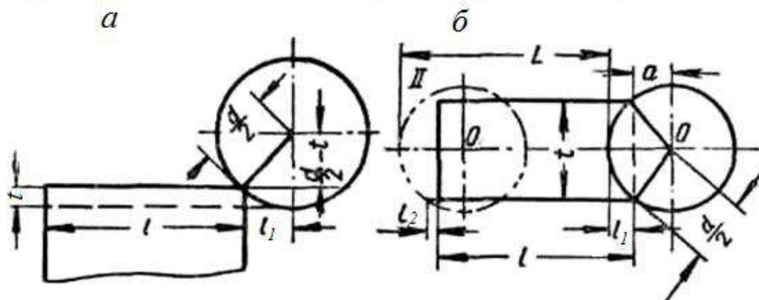
Рис. 5.9. Величины врезания при фрезеровании:
