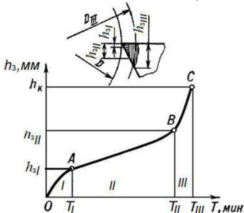
Рис. 1.18. Характер изнашивания задней поверхности режущего инструмента:
