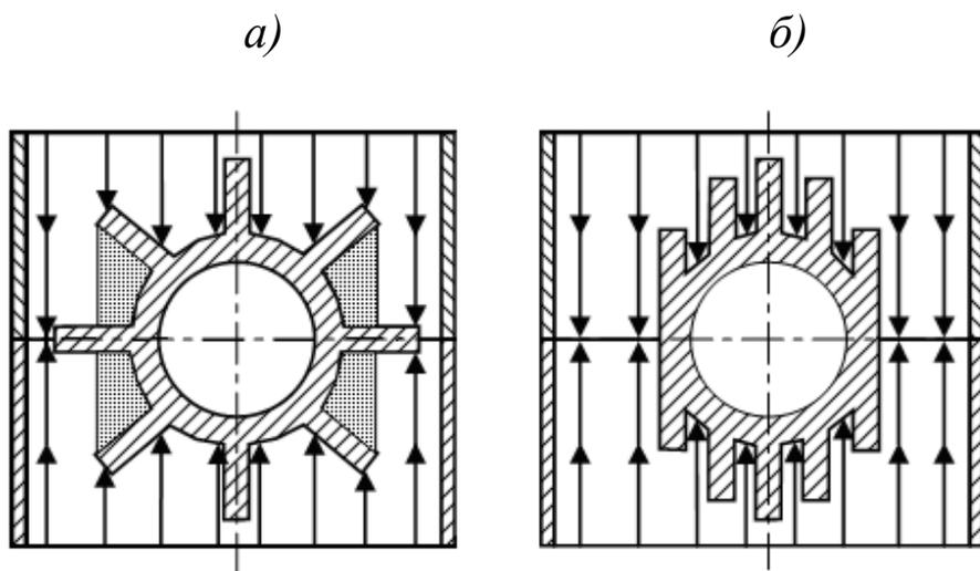
Рис. 6.3. Использование правила параллельных лучей
