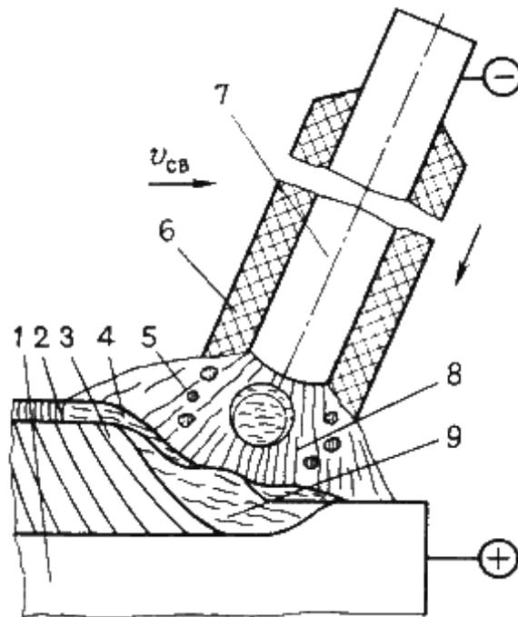
Рис. 17.2. Схема процесса сварки металлическим покрытым электродом
