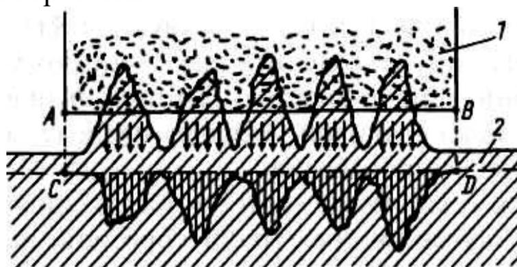
Рис. 11. Схема образования неоднородности поверхностного слоя при шлифовании
