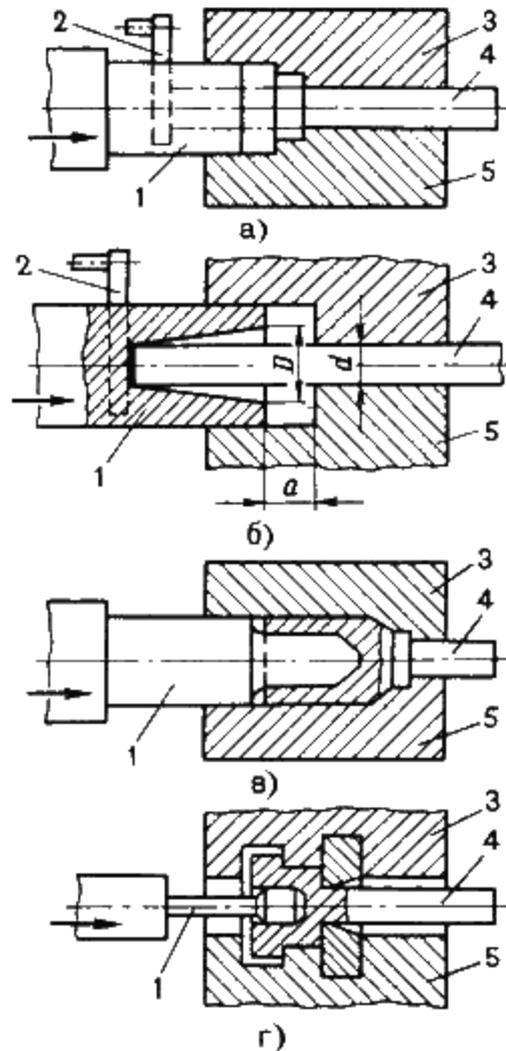
Рис. 14.4. Схема горячей объемной штамповки на горизонтально-ковочной машине
