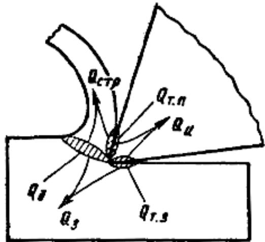
Количественное выражение составляющих уравнения теплового баланса зависит от вида операции, физико-механических свойств материала заготовки и инструмента, режима резания и геометрических параметров инструмента, условий обработки.
