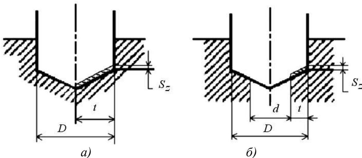
Рис. 2.2. Схема резания при сверлении.
