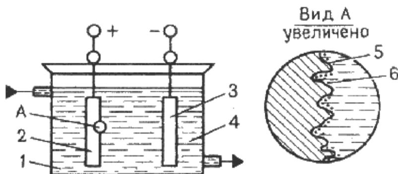
Рис. 8.6. Схема электрохимического полирования:
