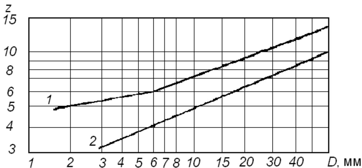
Рис. 2.1. Зависимость числа зубьев развертки от диаметра обработки:
