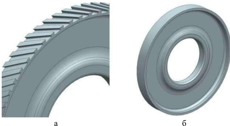
Рис. 4 - а) пазы типа «ласточкин хвост», б) диск-заготовка
