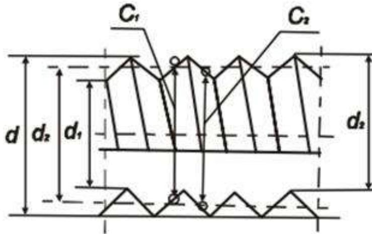
Рис. 8.2. Средний диаметр метчика.
