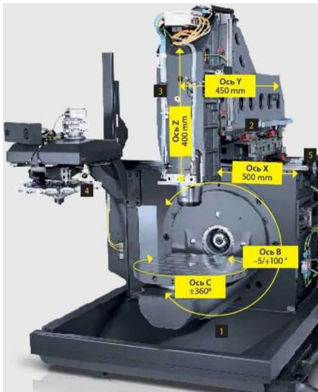
1 - C-образная станина из серого чугуна; 2 - роликовые направляющие качения на всех осях; 3 - мотор-шпиндель; 4 - магазин инструментов; 5 - шаговые двигатели привода подачи
