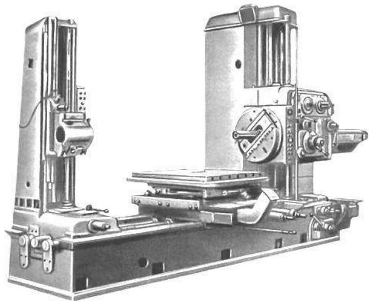
Горизонтально расточные станки (рис. 4.12) предназначены для черновой и чистовой обработки отверстий (сверление, зенкерования, развертывание, растачивание и др.), обтачивания цилиндрических наружных поверхностей, подрезки торцов, выточки канавок, нарезания резьб и др. На этих станках в основном обрабатывают крупные детали (корпусные). Возможные схемы обработки приведены на рис. 4.13.
