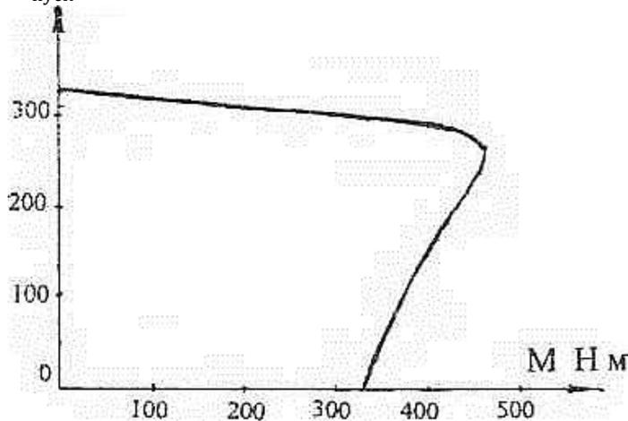
Рисунок 1.2 Естественная механическая характеристика асинхронного электродвигателя типа АИР225М2
