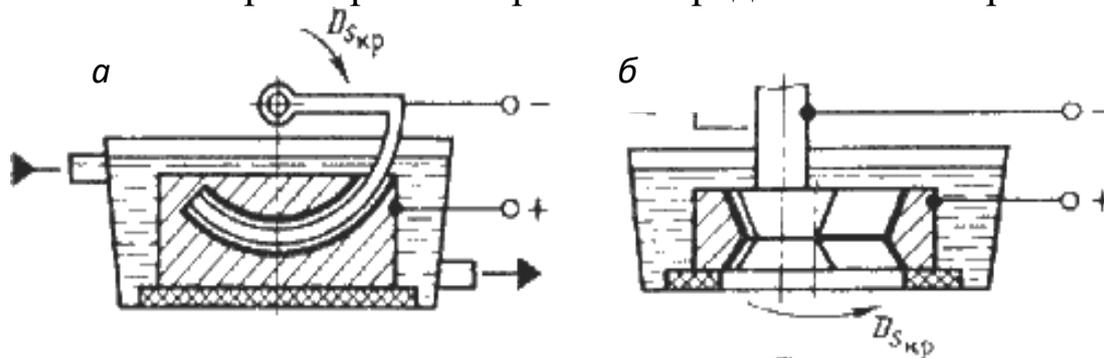
Рис. 8.3. Схемы электроискровой обработки:
