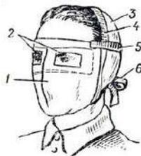
Рис.8.3. Противопыльная тканевая маска
