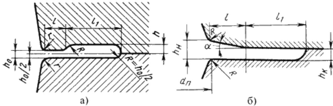
Рис.14.1. Виды облойной канавки при штамповке на молотах
