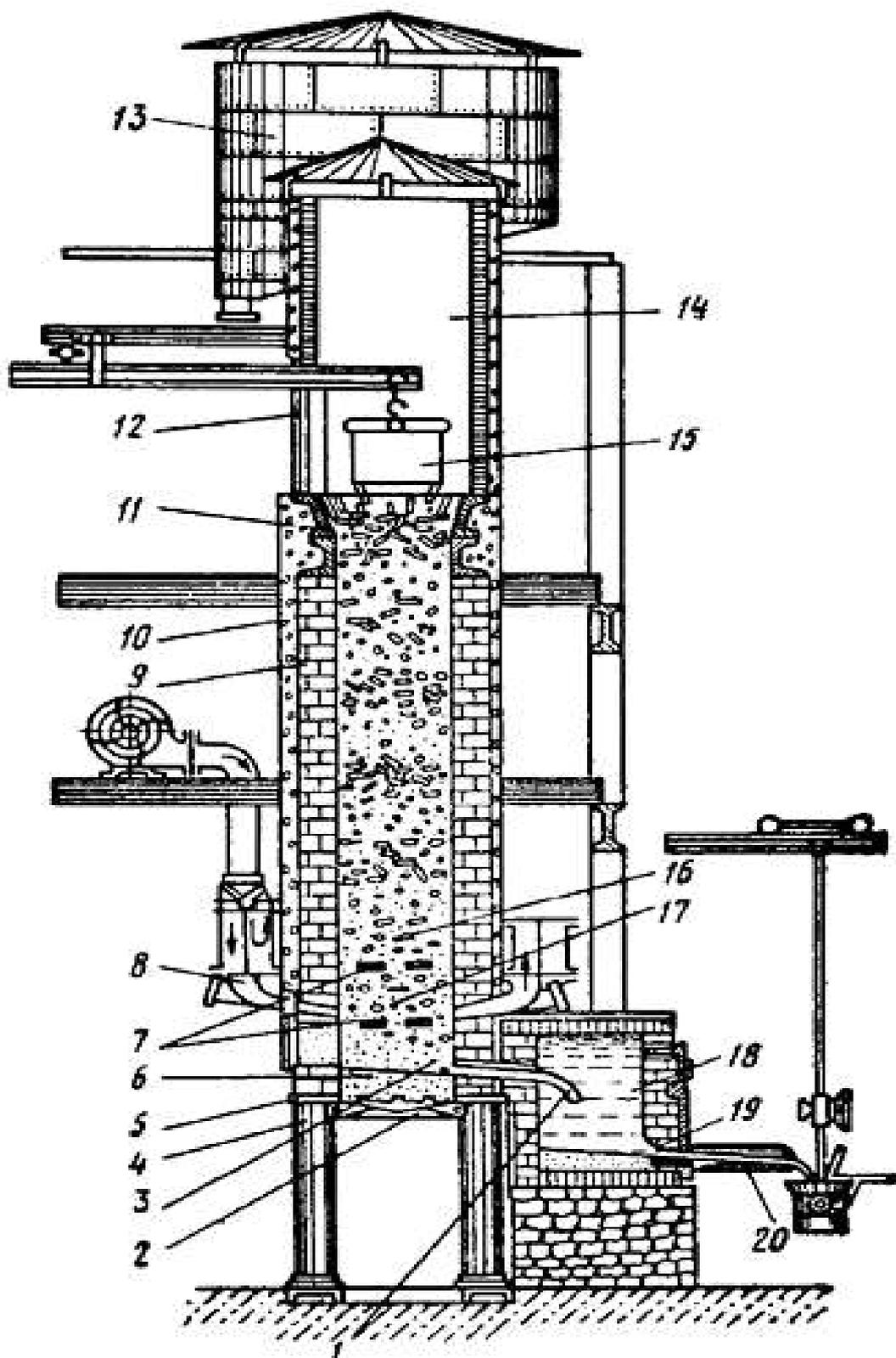
Рис.1.1. Схема устройства вагранки открытого типа с копильником:
