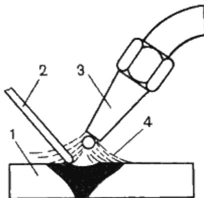
Рис. 17.6. Схема газовой сварки
