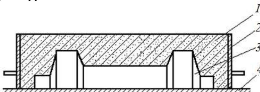
Рис. 4.5. Изготовление нижней полуформы:
