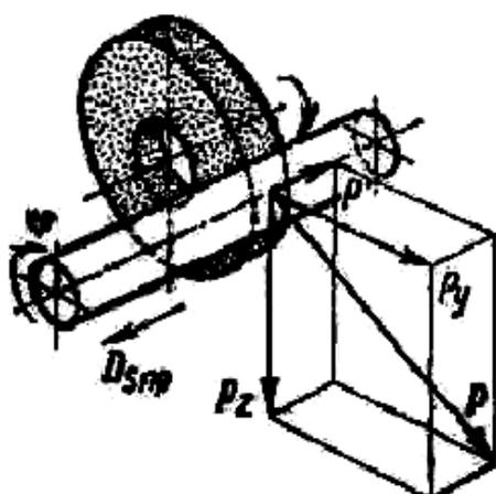
Рис. 7.8. Схемы составляющих силы резания при наружном круглом шлифовании в центрах
