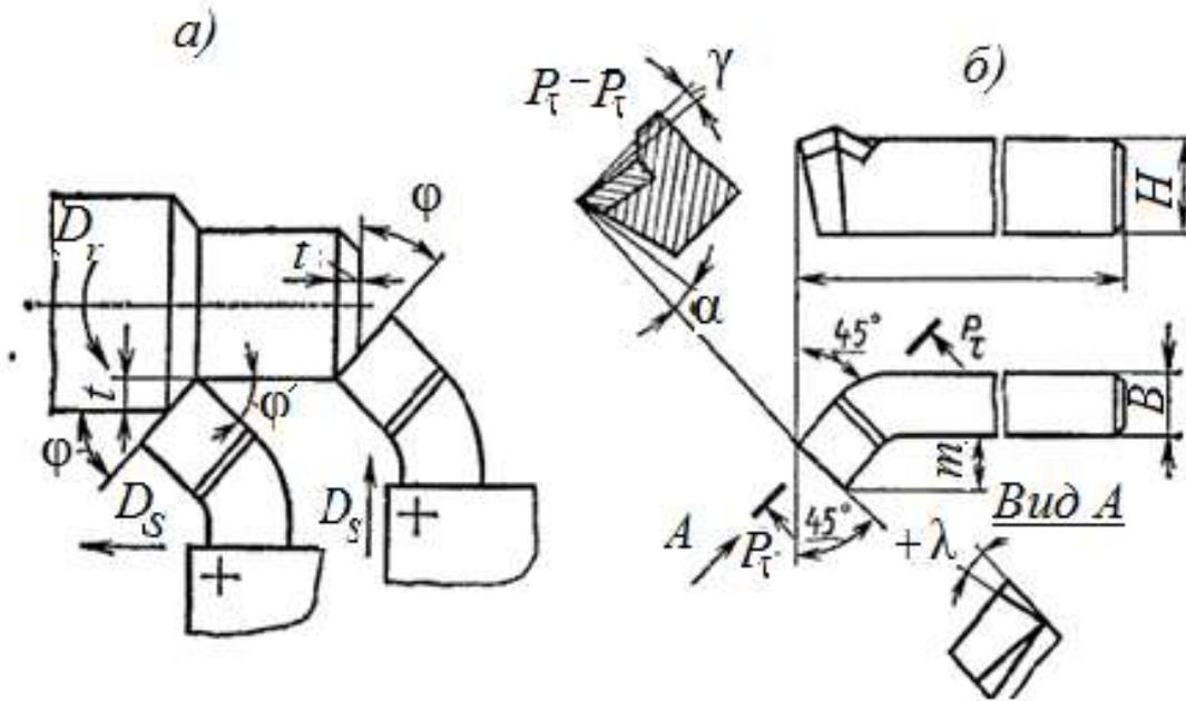
Рис. 2.3. Токарный проходной отогнутый резец: а) схема точения; б) проходной отогнутый резец (геометрические параметры)
