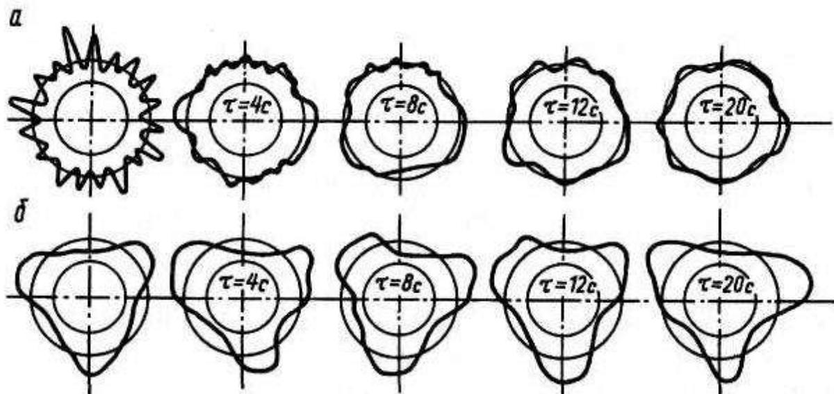
ков) зажимного патрона. При использовании патронов с двумя кулачками на отверстии возникнет овал, а при использовании четырех кулачков – четыре явно выраженные волны на отверстии детали и т. д.
