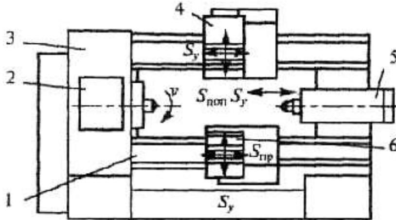
Рис. 3.12. Токарный многорезцовый полуавтомат:
