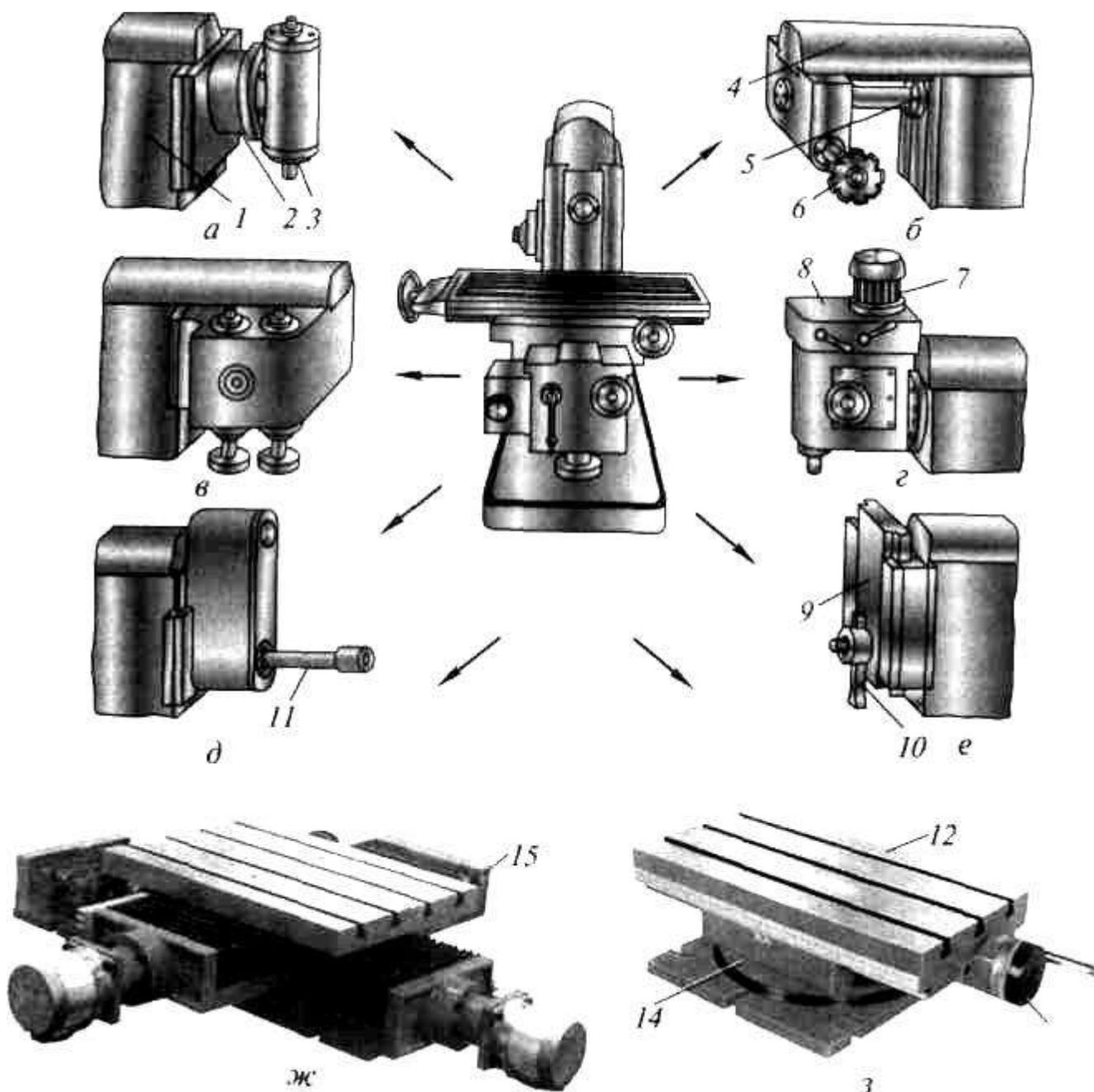
Рис.1. Приспособления, расширяющие технологические возможности фрезерных станков:
