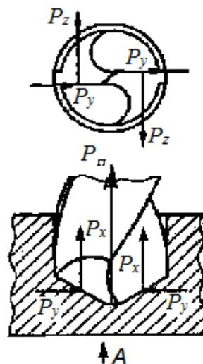
Рис. 4.9. Силы сопротивления резанию при сверлении
