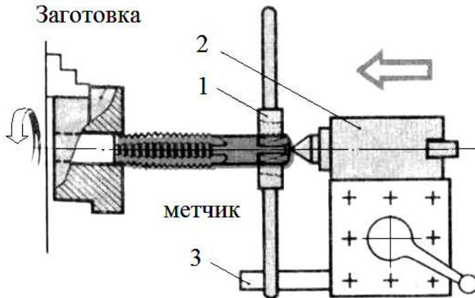
Рис. 4.2. Схема нарезания резьбы метчиком
