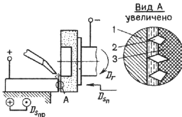
1 – заготовка; 2 – абразивные зёрна; 3 – связка шлифовального круга
