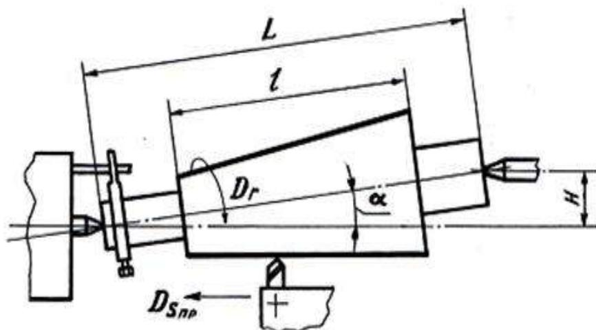
Рис. 3.4. Схема точения конуса смещением корпуса задней бабки
