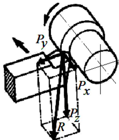
Радиальная составляющая силы резания  $P_y$  направлена по радиусу (перпендикулярно оси заготовки). Эта составляющая определяет силу отжима резца и прогиб заготовки, влияющие на точность обработки. По силе  $P_y$  рассчитывают на прочность механизм поперечной подачи.
