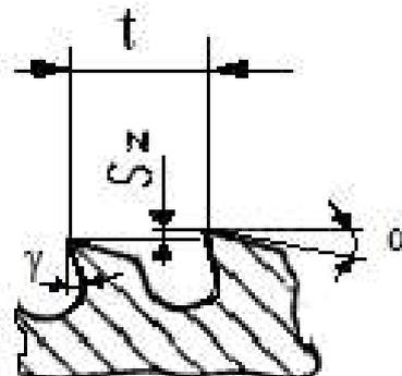
Рис. 6.9. Геометрические параметры зубьев протяжки
