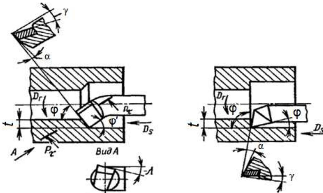
Рис. 3.5. Расточные токарные резцы:
