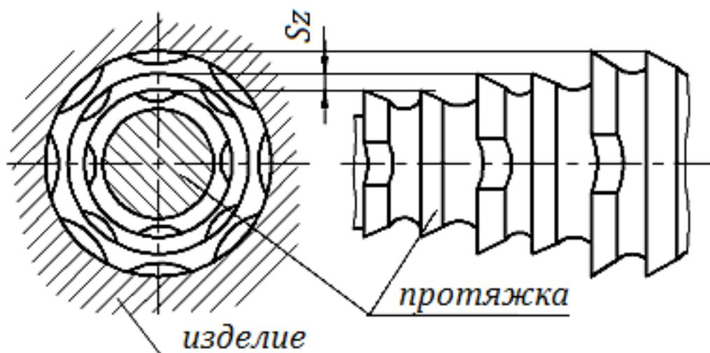
Рис. 10.4. Протяжная групповая схема резания
