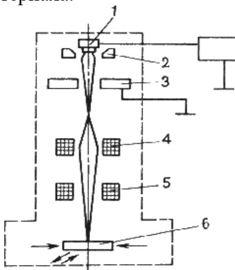
Рис. 8.10. Схема установки для электроннолучевой сварки:
