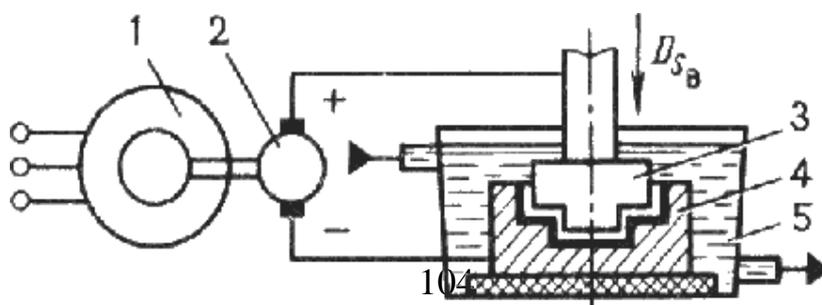
Рис. 8.4. Схема электроимпульсной обработки:
