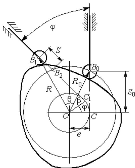
Рис.1.9. Расчётная схема построения профиля кулачка с роликовым толкателем
