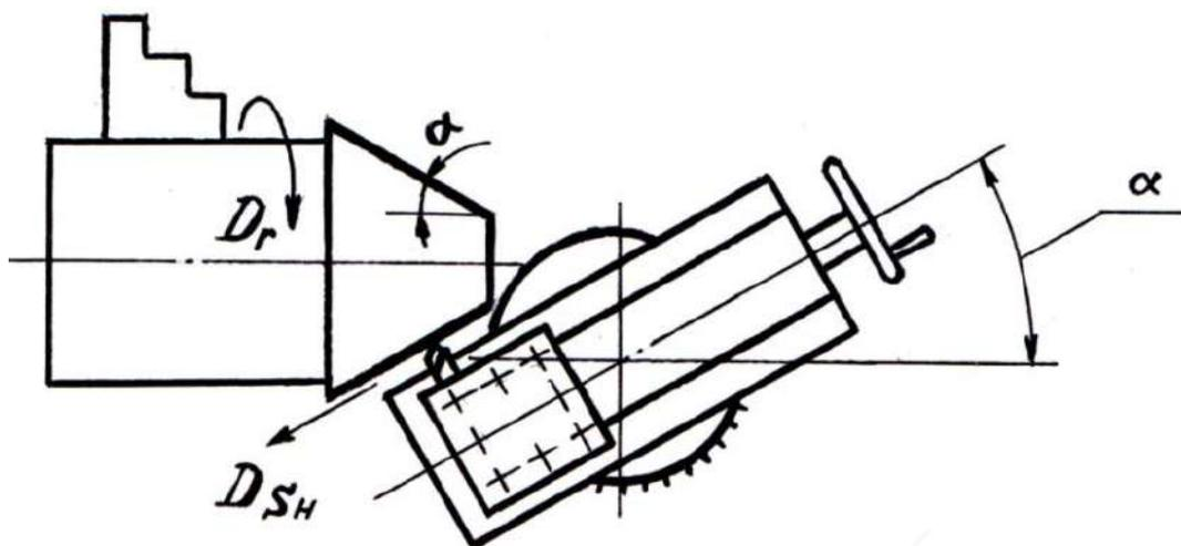
Рис. 3.3. Схема точения конуса с поворотом верхних салазок
