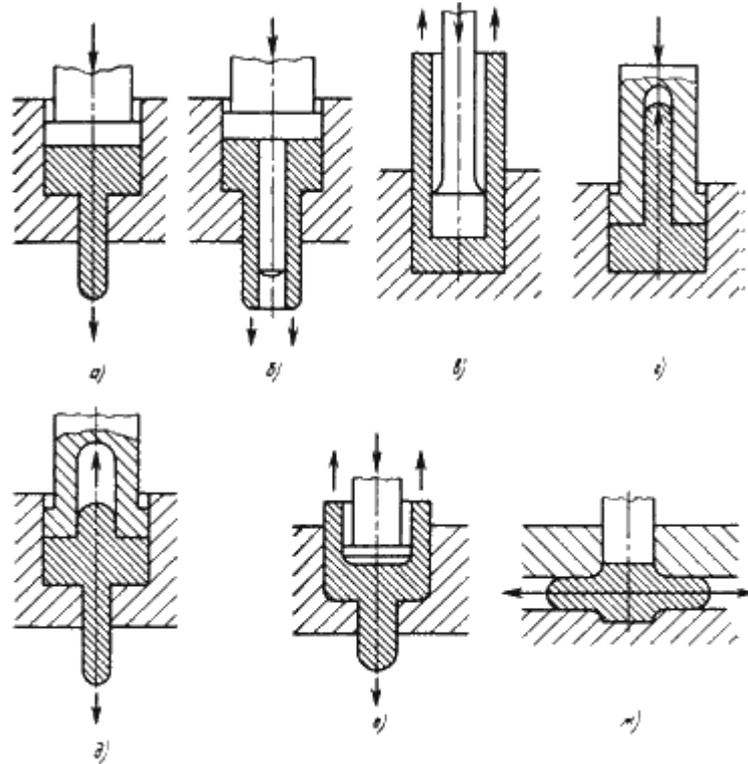
Рис. 15.3. Схемы выдавливания:
