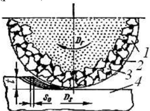
Рис. 3.1. Схема срезания припуска при шлифовании и конструктивные особенности абразивного инструмента:
