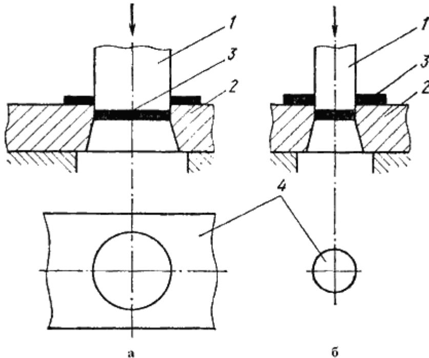
Рис. 15.6. Схема процессов вырубке (а) и пробивки (б)
