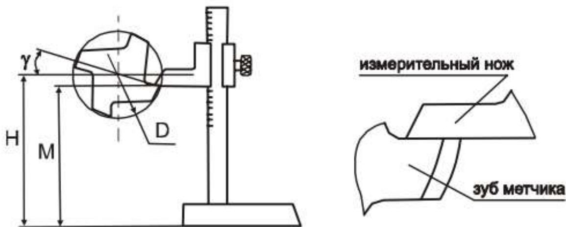
Рис. 8.5. Схема измерения переднего угла.
