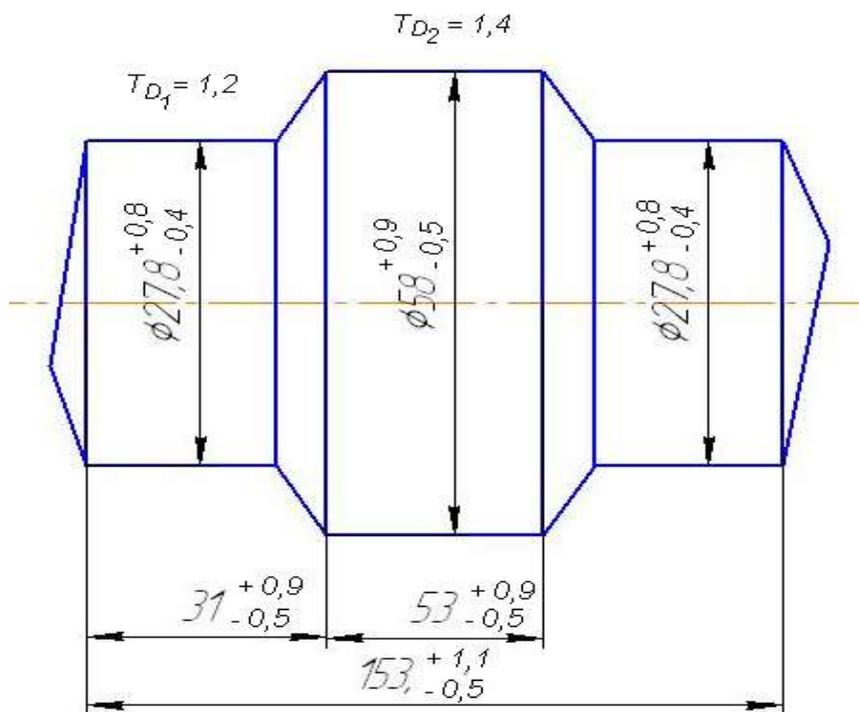
Рис. 4. Эскиз заготовки
