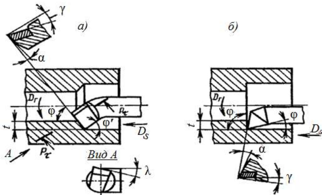
Рис. 2.6. Расточные токарные резцы:
