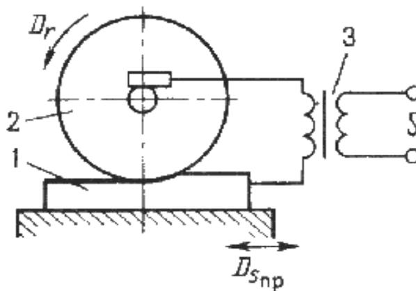
Рис. 8.5. Схема электроконтактной обработки плоской поверхности:
