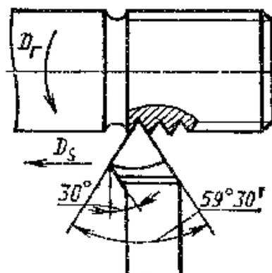
Рис. 2.9. Резьбовой резец
