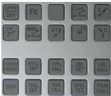
Рис. 14 - Клавиши открытия диалогов программирования
