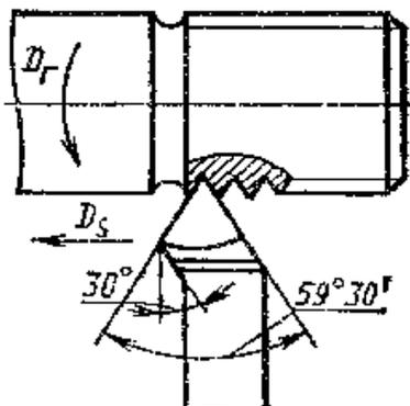
Рис. 3.8. Резьбовой резец
