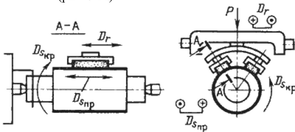
Рис. 7.11. Схема суперфиниширования
