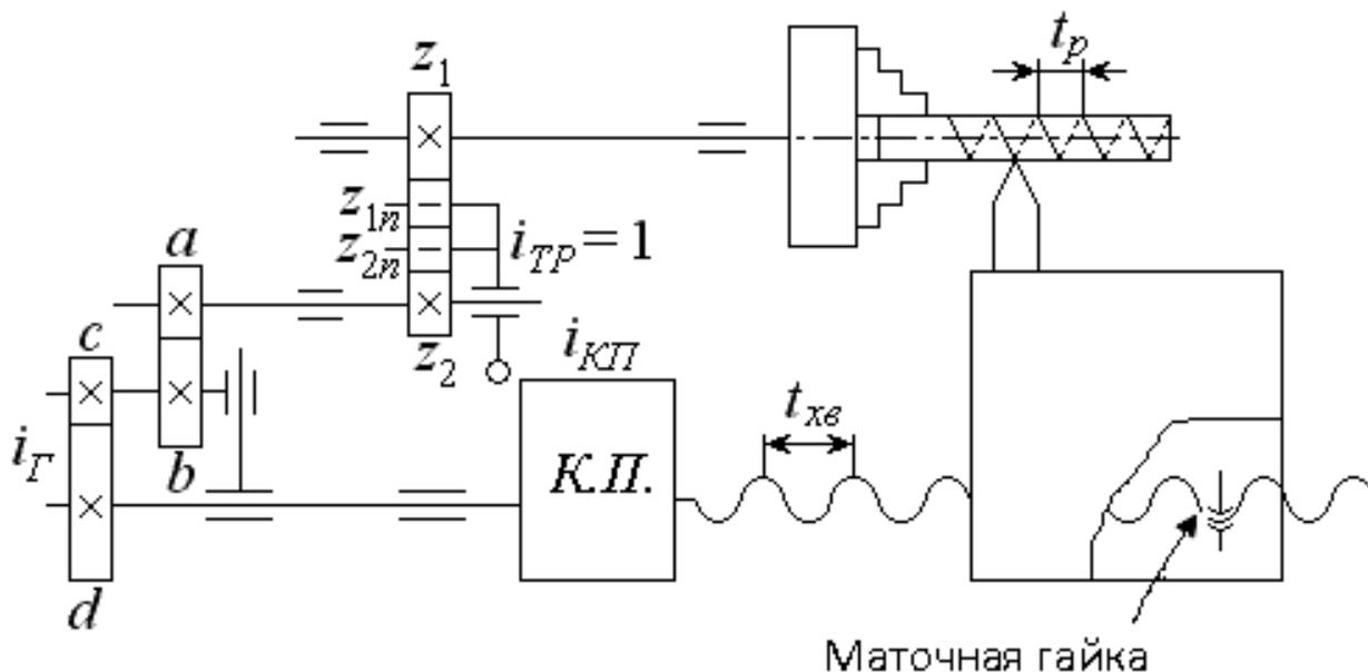
Рис. 5.2. Кинематическая цепь ТВС при нарезании резьбы
