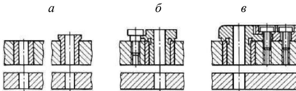
Рис. 13. Кондукторные втулки
