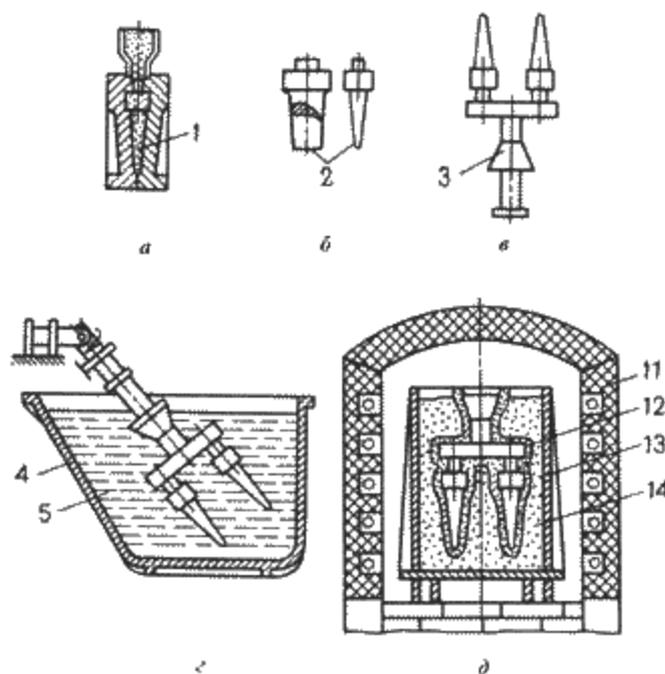
Рис.6.2. Технологические операции процесса литья по выплавляемым моделям
