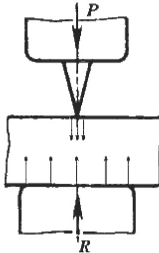
Рис.12.1. Схема рубки
