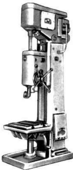
Рис. 4.10. Общий вид вертикально-сверлильного станка
