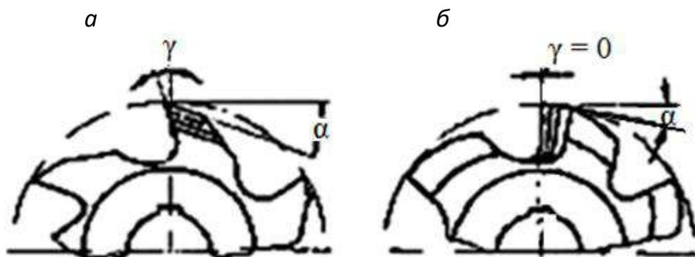
Рис. 5.2. Форма зубьев фрез:
