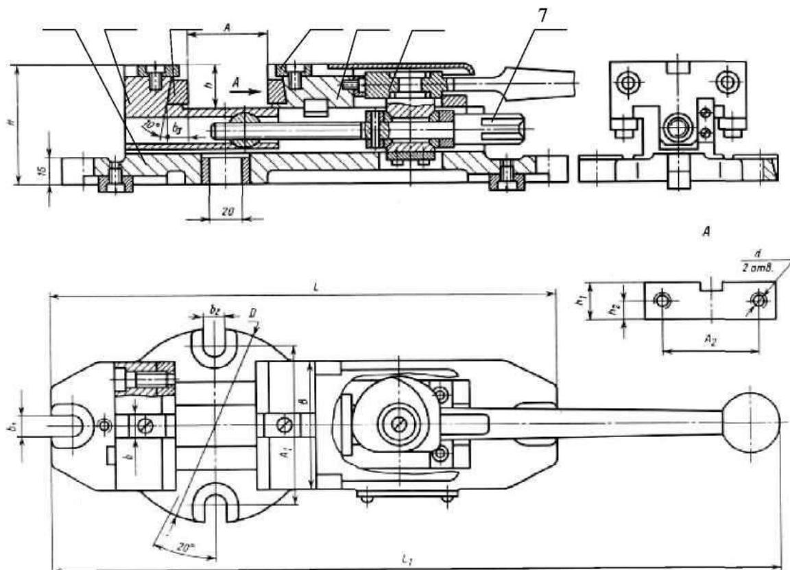
Рис. 15. Тиски станочные с эксцентриковым зажимом и одной подвижной губкой
