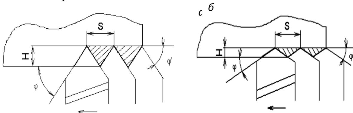
Рис. 1.5. Влияние углов  $\varphi$  и  $\varphi'$  на шероховатость обработанной поверхности:
