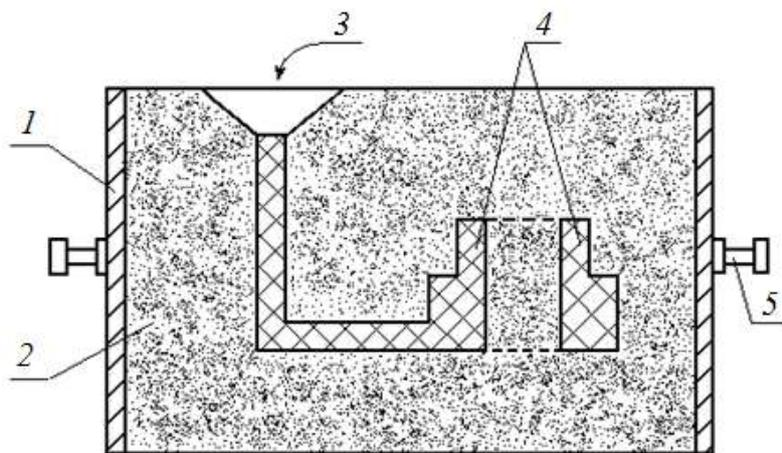
Рис. 5.4. Неразъемная форма с пенополистироловой моделью:
