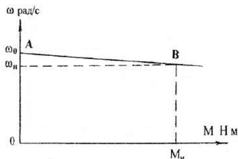
Рисунок 3.1- Построение естественной механической характеристики ДПТ независимого возбуждения
