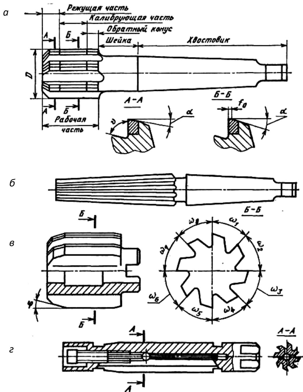
Рис. 4.7. Конструкции разверток:
