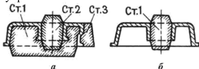
Рис. 8.6. Конструкция литой детали: а – нетехнологичная; б - технологичная
