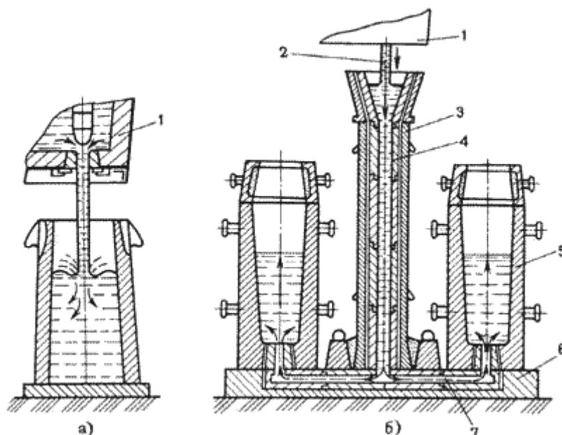
Рис.3.3. Разливка стали в изложницы
