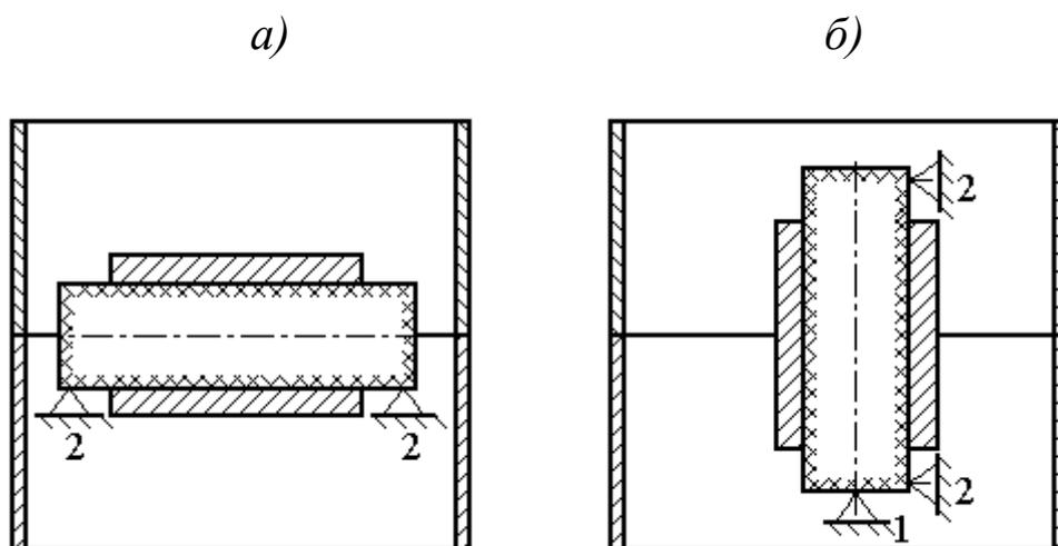
Рис. 6.4. Варианты расположения пустотелой отливки
