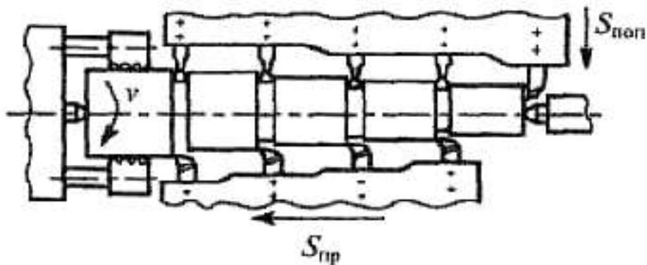
Рис. 3.13. Схема обработки заготовки на многорезцовом полуавтомате
