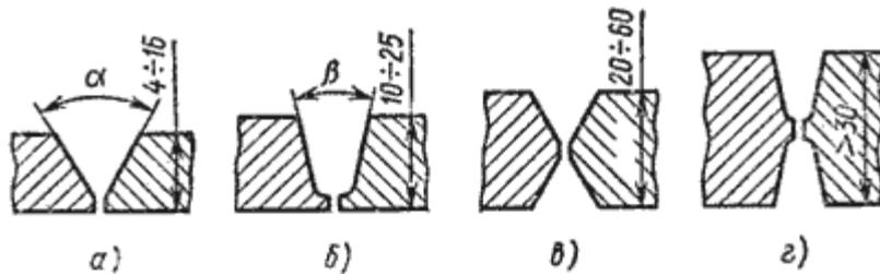
Рис. 18.3. Формы подготовки кромок под сварку:
