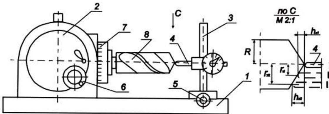
Рис. 6.3. Установка для измерения заднего угла сверла.
