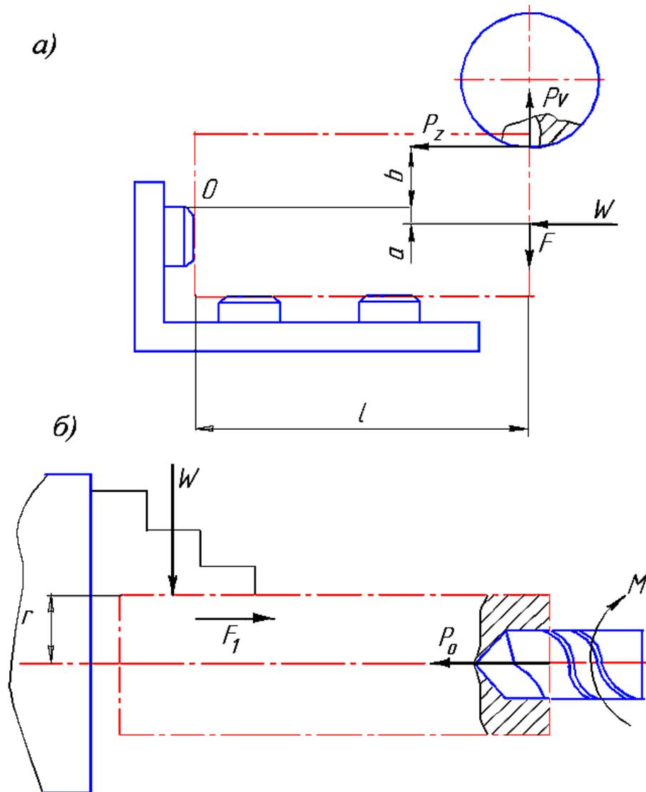
Рис. 3. Расчетные схемы
