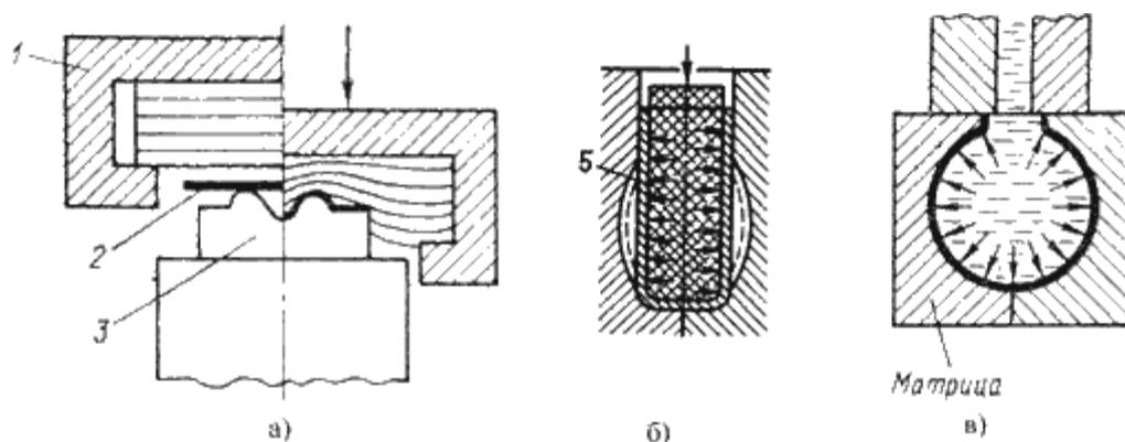
Рис.16.4. Схема холодного прессования: а – одностороннего; б – двустороннего
