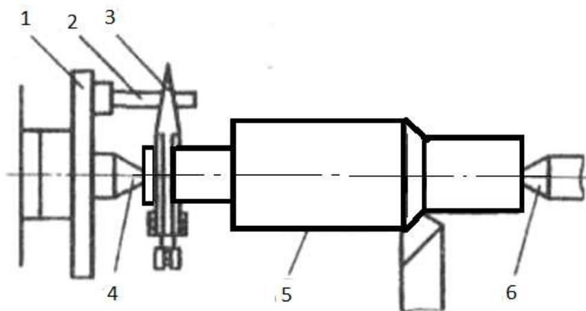
Рис. 3.19. Обработка заготовки в центрах с приводом от поводкового патрона:
