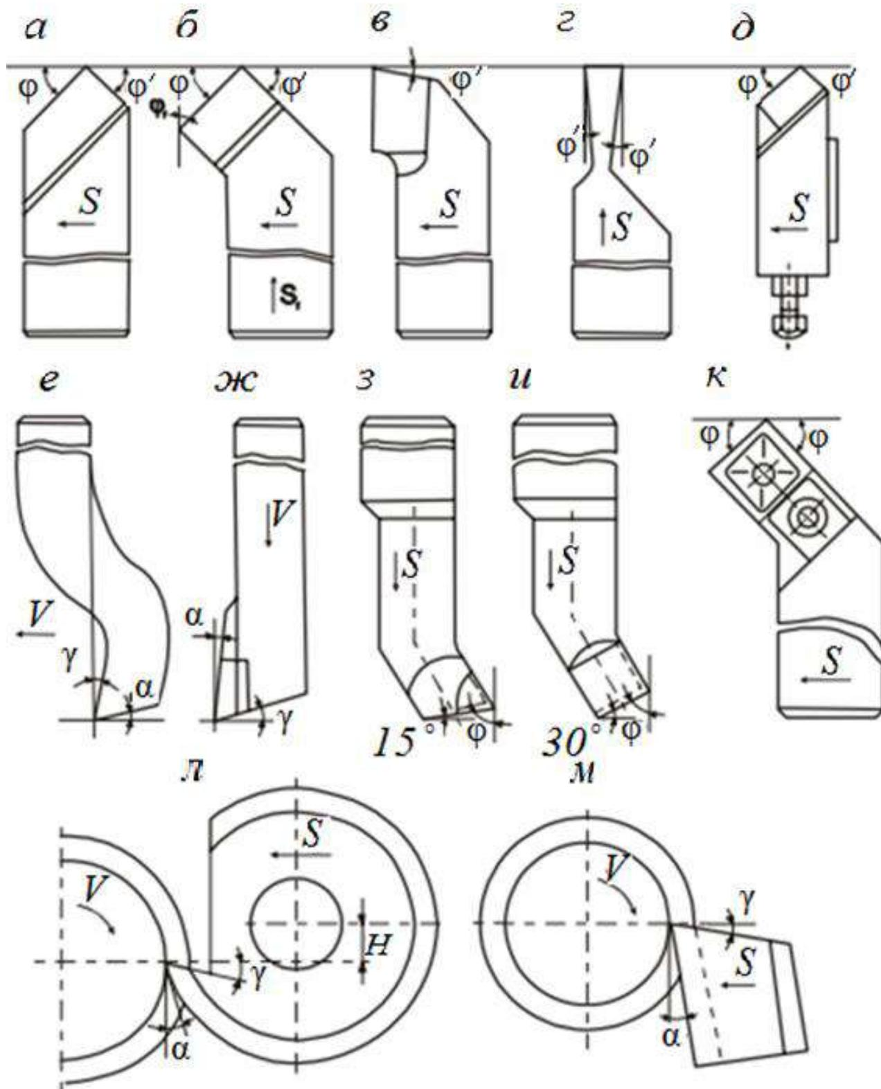
Рис. 2.1. Типы резцов: *a* – прямой проходной; *б* – отогнутый проходной; *в* – упорный подрезной; *г* – отрезной; *д* – автоматный; *е* – строгальный; *ж* – долбежный; *з* – расточной для глухих отверстий; *и* – расточной для сквозных отверстий; *к* –
