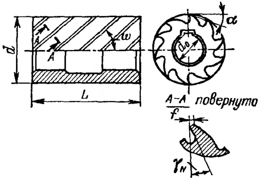
Рис. 5.3. Цилиндрическая фреза
