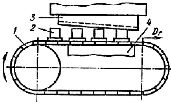
Рис. 6.13. Схема обработки на протяжном станке непрерывной обработки:
