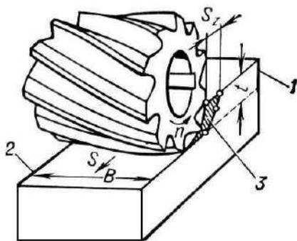
Рис. 2.4. Схема резания при фрезеровании цилиндрической фрезой:
