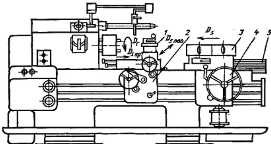
Рис. 3.10. Токарно-револьверный станок с вертикальной осью револьверной головки:
