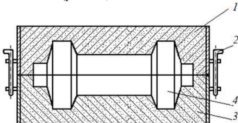
Рис. 6. Изготовление верхней полуформы:
