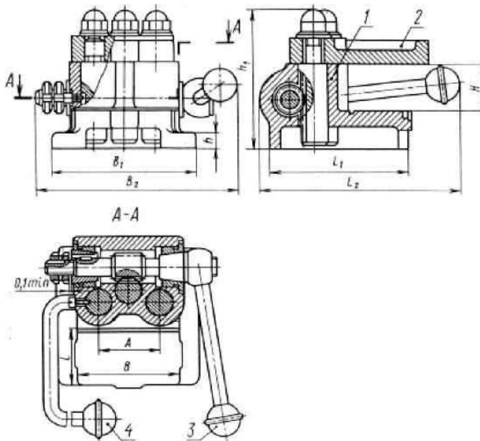
Рис. 14. Кондуктор скальчатый с конусным зажимом
