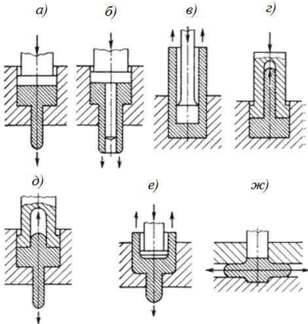
Рис. 3.3. Схемы выдавливания
