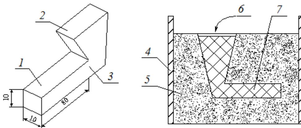
Рис. 5.5. Пенополистироловая модель для изготовления испытуемого образца и её расположение в опоке:
