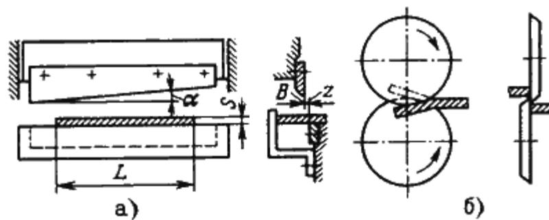
Рис. 15.5. Схемы действия ножниц: а – гильотинных; б – дисковых
