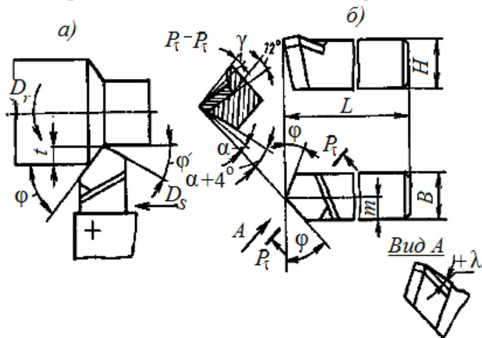
Рис. 2.2. Токарный прямой проходной резец:
