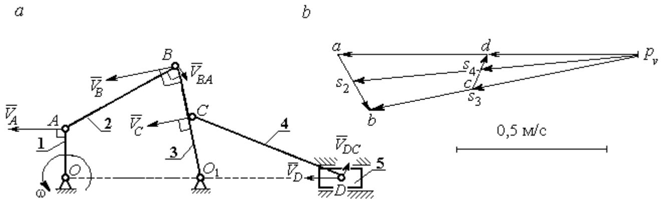
Рис. 3.5. План скоростей механизма:
