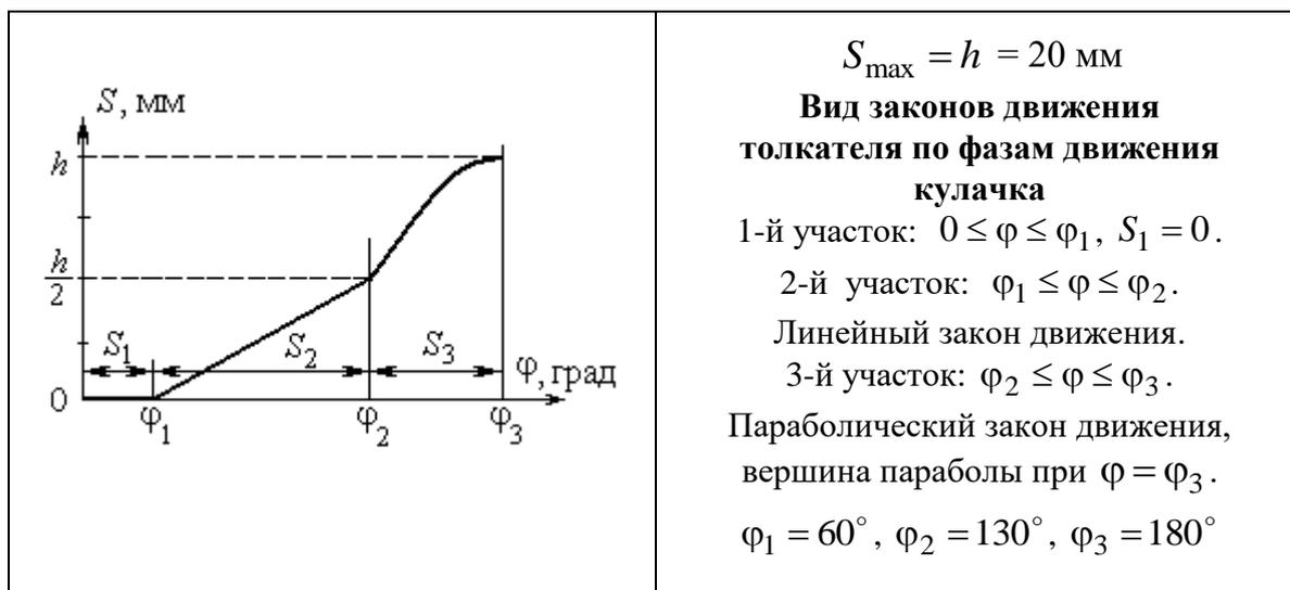
Рис. 1.4. Примерный закон движения толкателя
