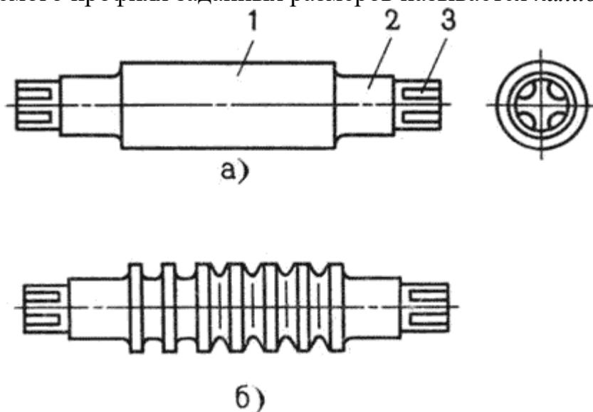
Рис. 10.3. Прокатные валки: а – гладкий ; б – калиброванный
