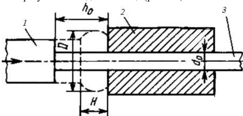
Рис. 3.1. Схема высадки
