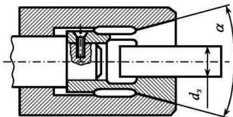
Рис. 32. Схема закрепления заготовки на цанговой оправке
