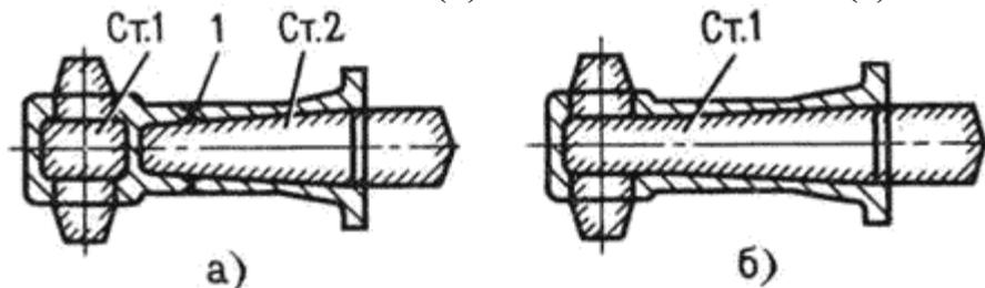
Рис. 8.8. Конструкция литой детали: а – нетехнологичная; б - технологичная
