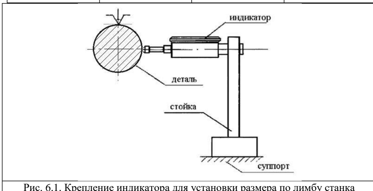
Рис. 6.1. Крепление индикатора для установки размера по лимбу станка
