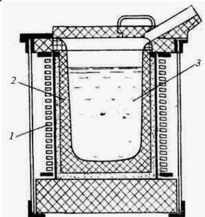
Рис. 2.2. Высокочастотная печь
