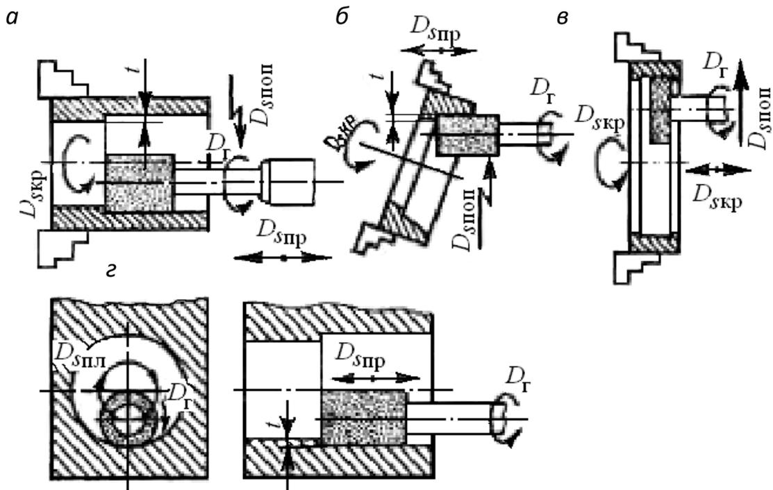
Рис. 7.6. Схемы обработки заготовок на внутришлифовальных станках:
