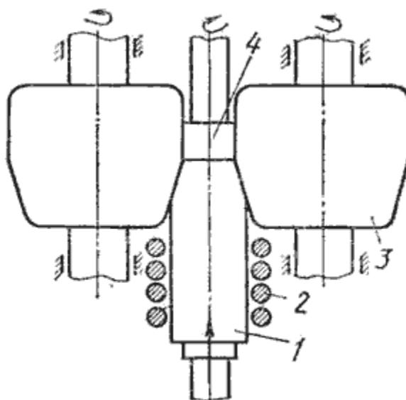
Рис 11.4. Схема прокатки шестерни с осевой подачей заготовки
