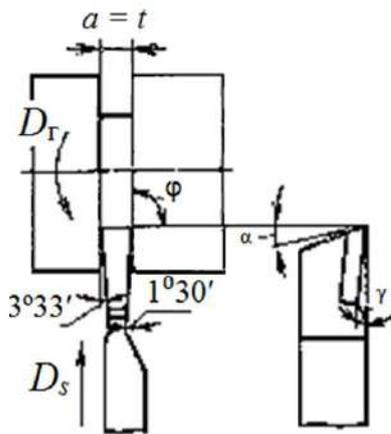
Рис. 3.6. Отрезной резец
