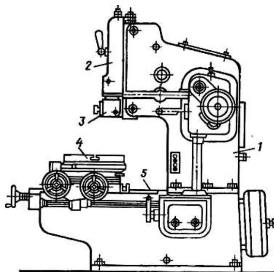
В станине 1 расположены все механизмы станка. В ее вертикальных направляющих движется ползун 2, совершающий вниз рабочий ход и вверх вспомогательный ход. В резцедержателе 3 крепят резец. Деталь устанавливают на столе 4, перемещающемся по направляющим 5. Стол, кроме того, может вращаться.
