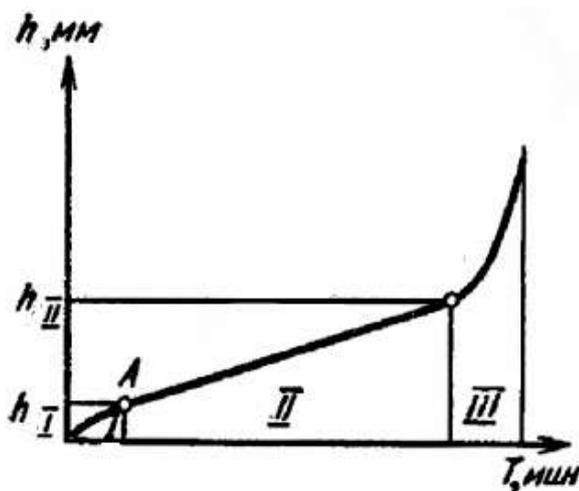
Рис. 7. Кривая износа поверхности во времени
