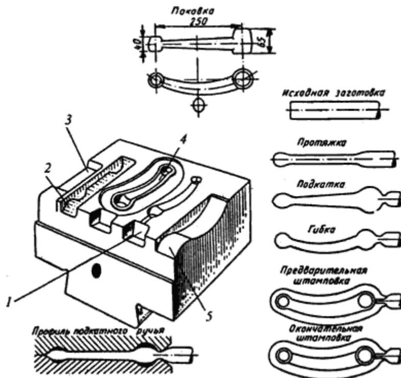
Рис. 13.1. Стадии получения сложной поковки в нескольких ручьях
