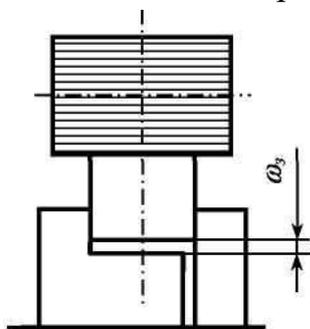
Рис. 36. Погрешность закрепления
