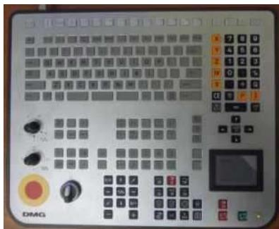
Рис. 2 - Пульт управления контурной системой ЧПУ iTNC 530
