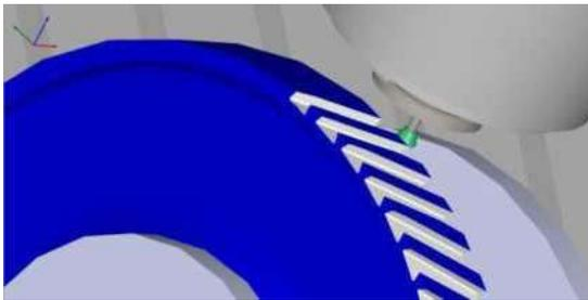
Рис. 20 - Процесс фрезерования пазов типа «ласточкин хвост»
