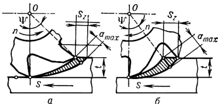
Рис. 2.5. Схемы фрезерования:
