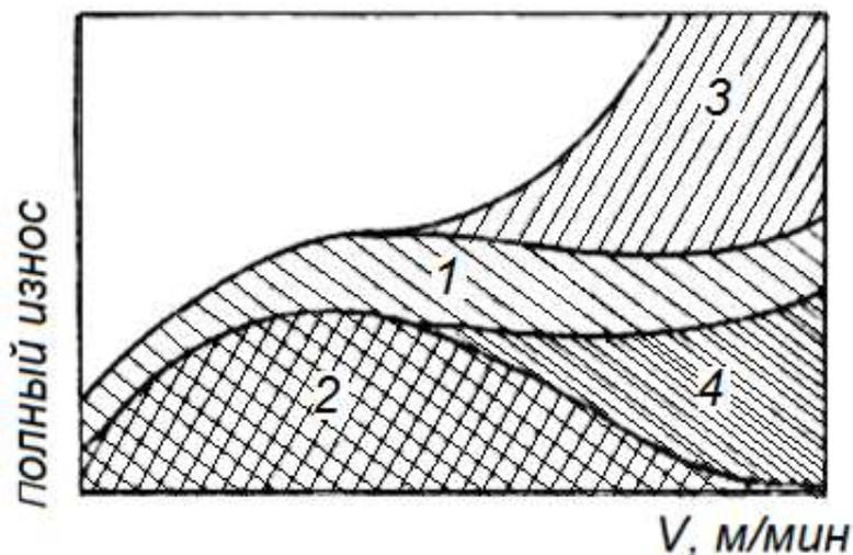
Рис. 1.16. Основные причины износа режущего клина и их влияние на износ в зависимости от скорости резания
