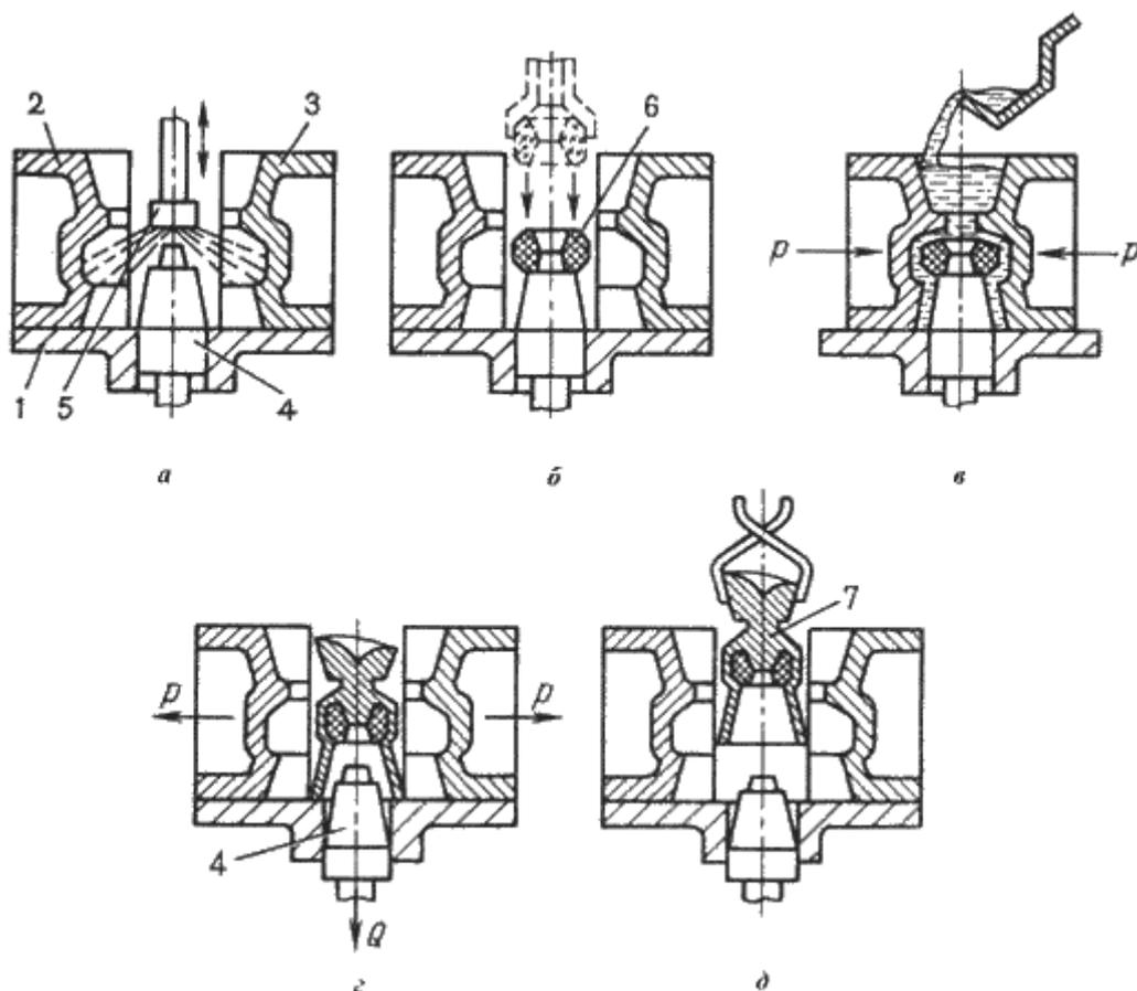
Рис. 6.3 Технологические операции изготовления отливки в кокиль
