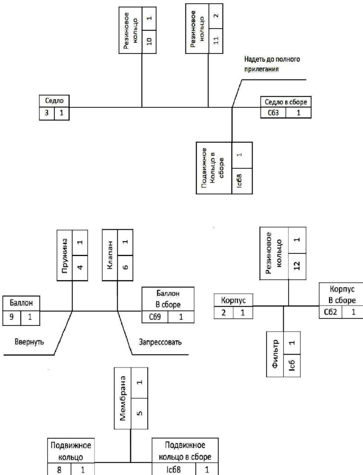
Рис. 33. Технологические схемы узловой сборки
