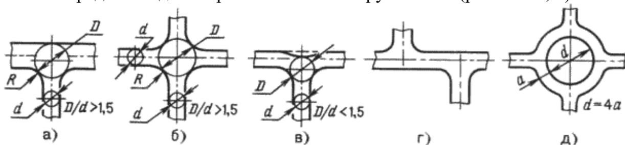
Рис.8.2. Устранение местного скопления металла в стенках отливки
