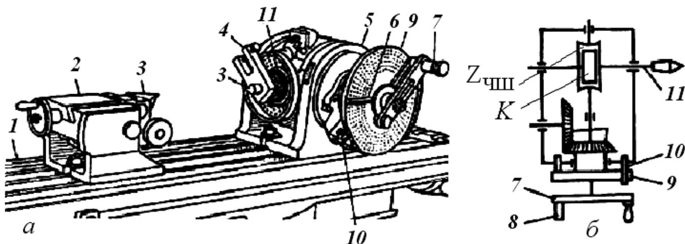
Рис. 9. Делительная головка:
