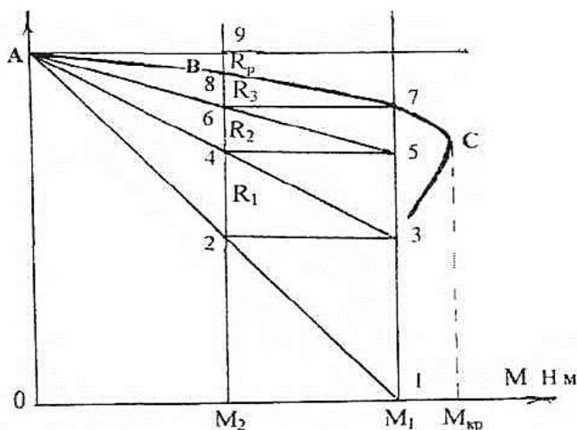
Рисунок 2.3 - Пусковая диаграмма АД с фазным ротором
