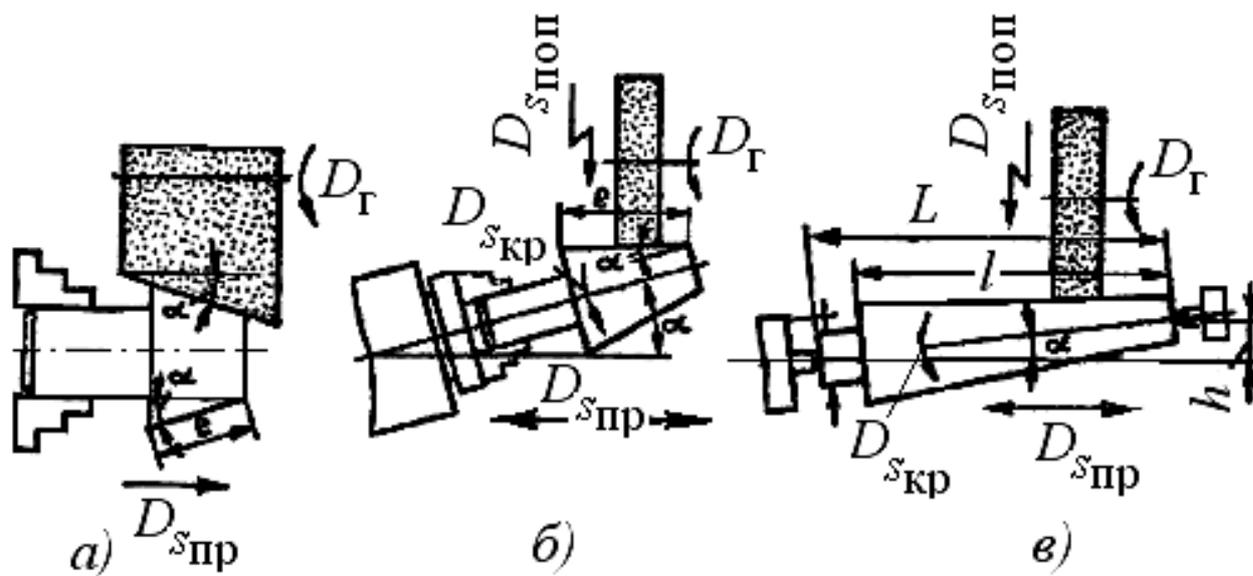
Рис. 3.4. Схемы обработки конических поверхностей на круглошлифовальном станке.
