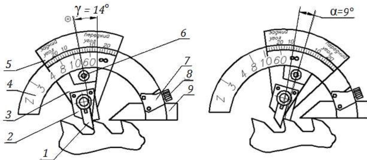
Рис. 10.5. Контроль углов протяжки угломером типа 2 УРИ
