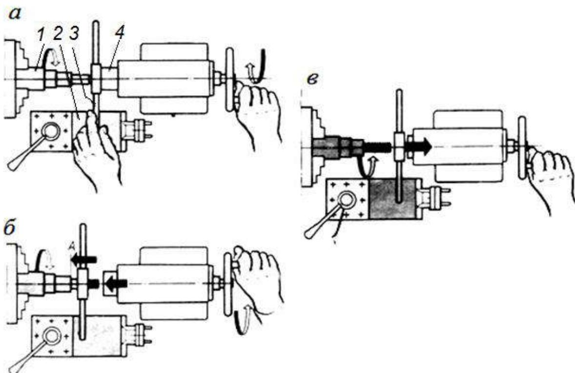
Рис. 4.1. Схема нарезания резьбы плашкой
