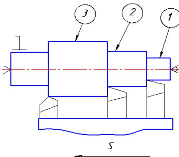
Рис. 3. Схема одного перехода точением нескольких поверхностей одновременно
