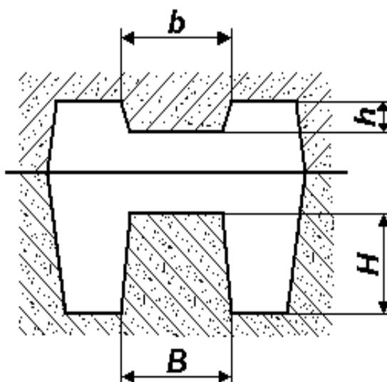
Рис. 6.9. Применение «болванов» для выполнения полостей отливки
