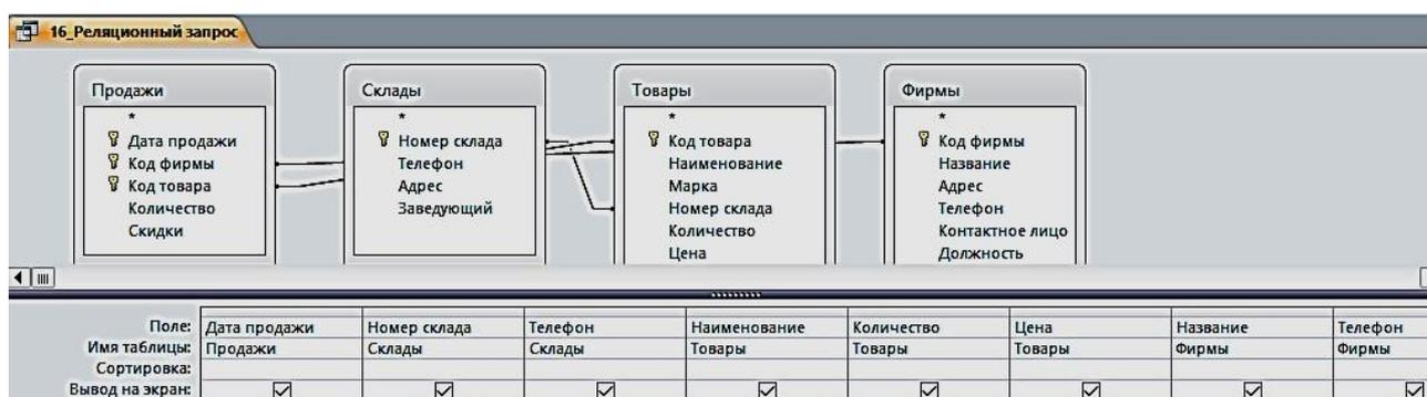
Рис. 3.10. Реляционный запрос в режиме Конструктора
