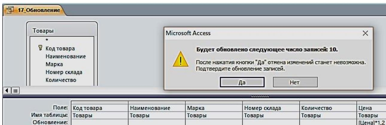
Рис. 3.12. Запрос на обновление в режиме Конструктора
