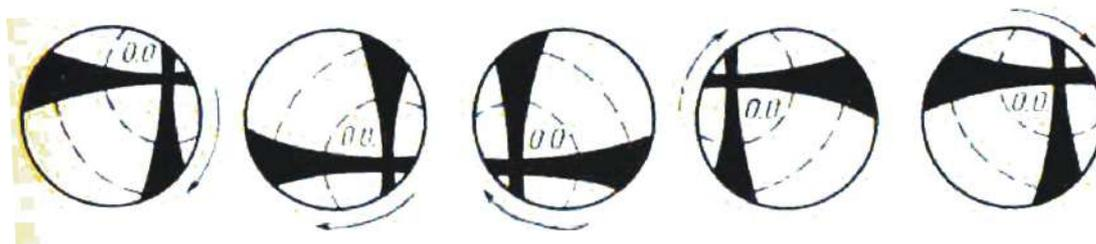
Рис. 17. Коноскопическая фигура одноосного кристалла в косом разрезе (стрелками показано направление вращения столика)
