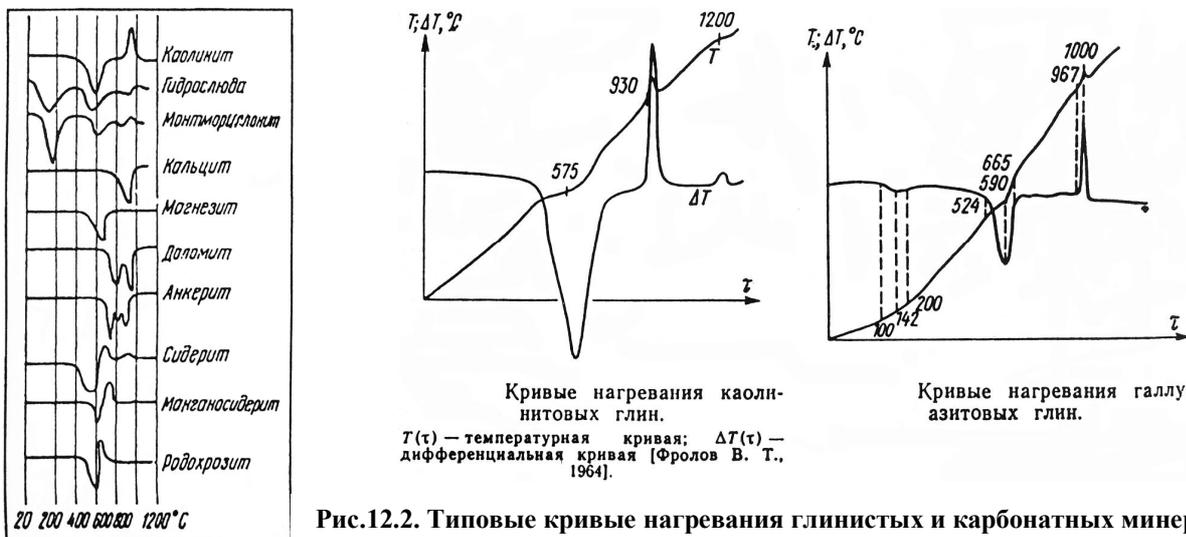
**Рис.12.2. Типовые кривые нагревания глинистых и карбонатных минералов**
