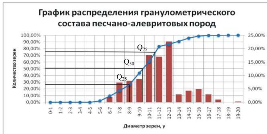
Рис. П.6. Пример нахождения квантилей по графику распределения гранулометрического состава
