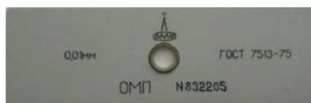
Рис. П.1. Объект-микрометр
