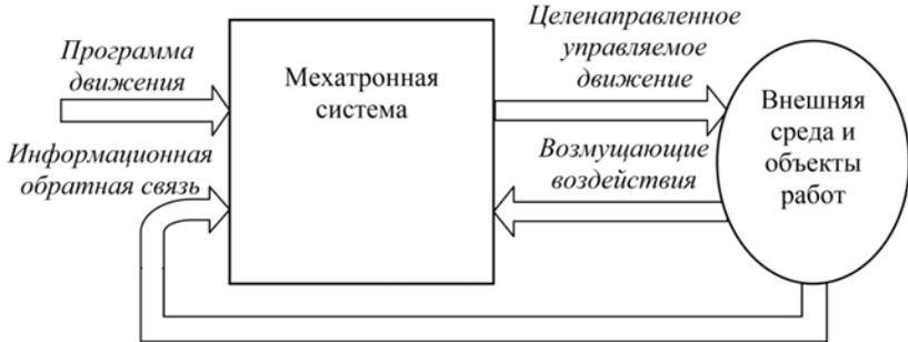
Рис. 8.2. Мехатронный модуль в виде «черного ящика»
