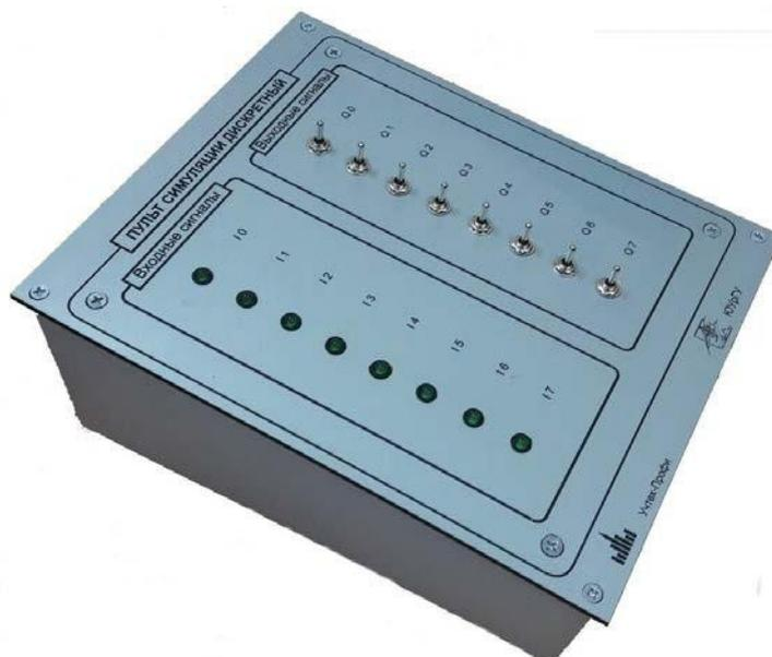
Рисунок 8 – Пульт ручного управления модулем
