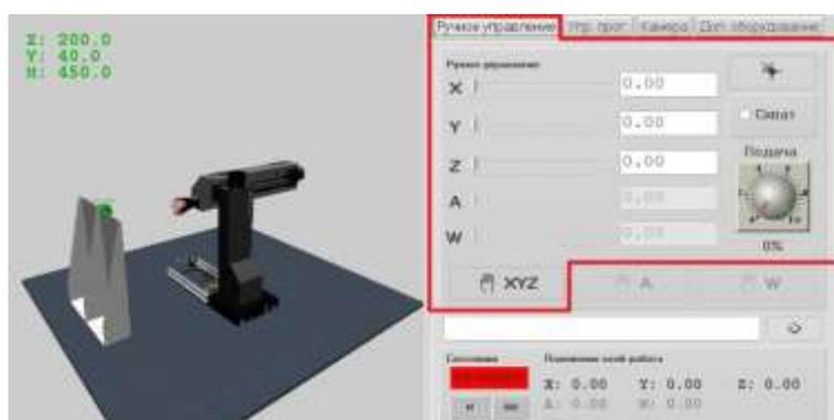
Рисунок 1.1 – Интерфейс ручного управления роботом–штабелером
