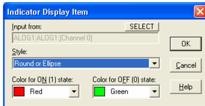
Рис. 4.56. Конфигурирование индикатора
