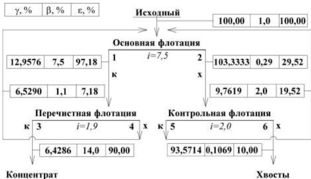
Рис. 6. Качественно-количественная схема обогащения
