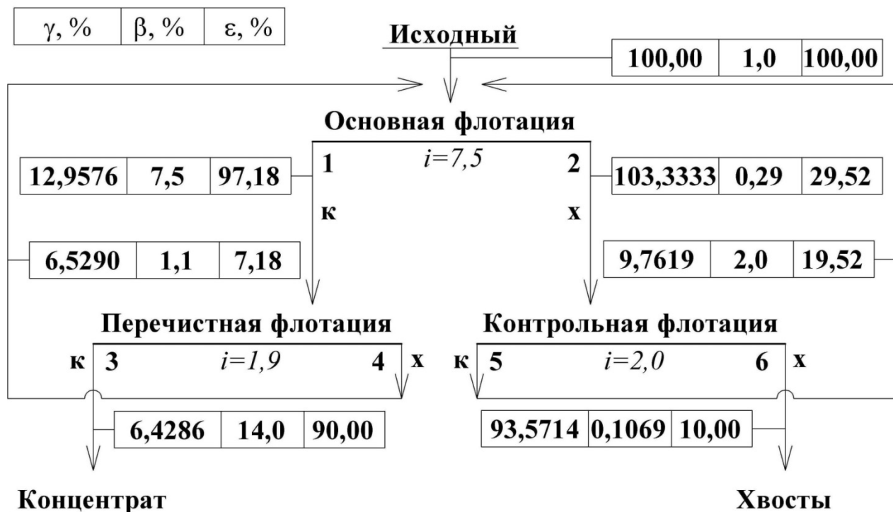
Рис. 6. Качественно-количественная схема обогащения
