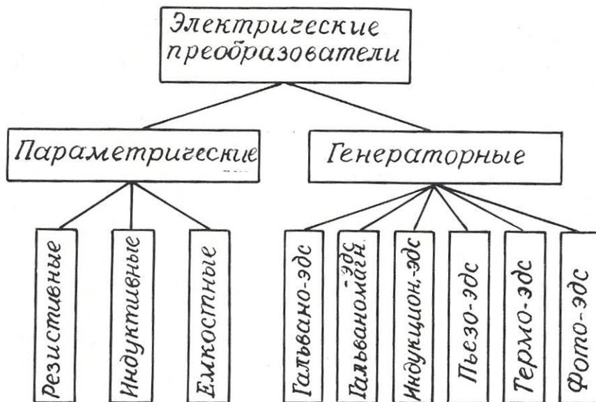
Рис. 1.2. Классификация электрических преобразователей
