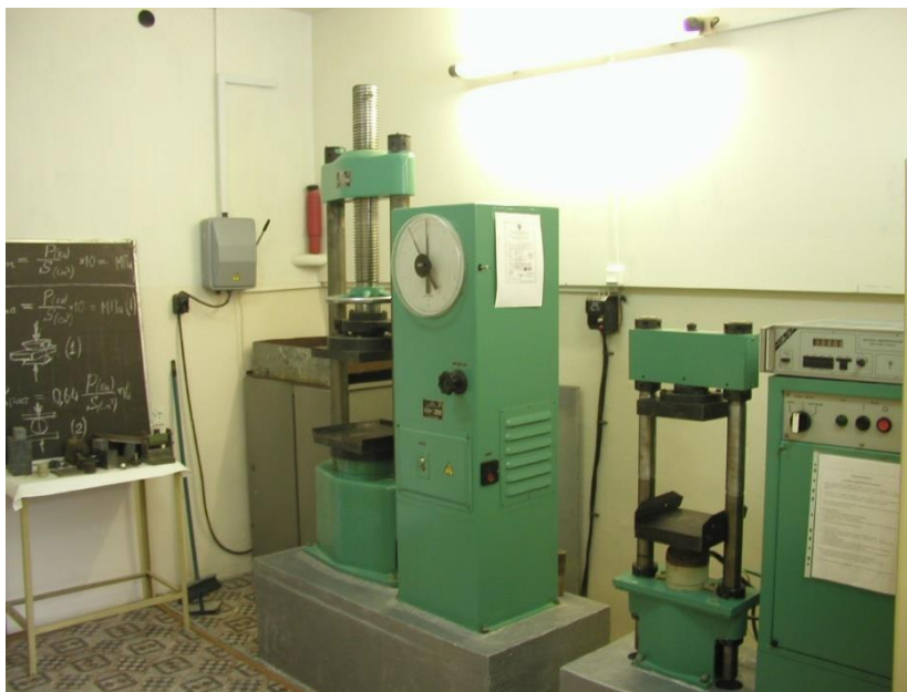
Рис. 1 Прессы в лаборатории физико-механических свойств горных пород
