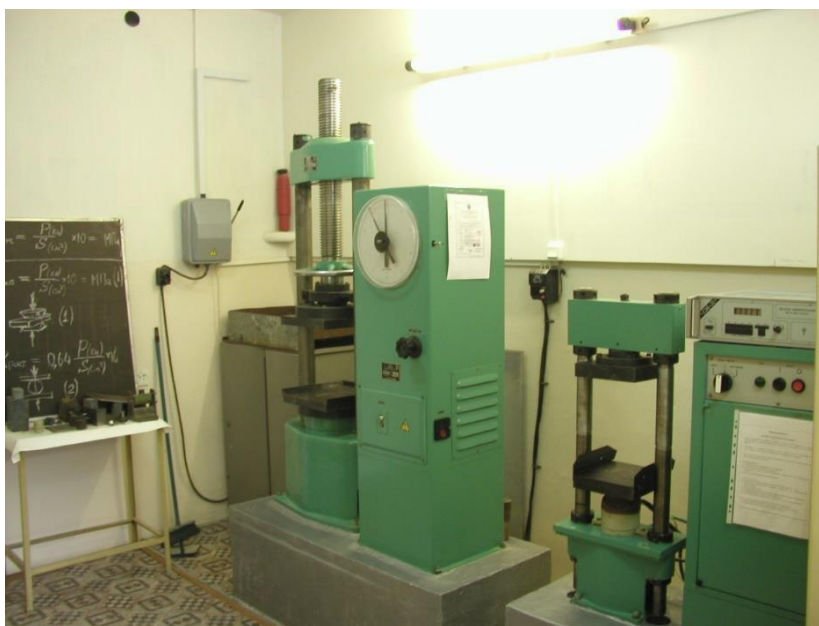
Рис. 1 Прессы в лаборатории физико-механических свойств горных пород
