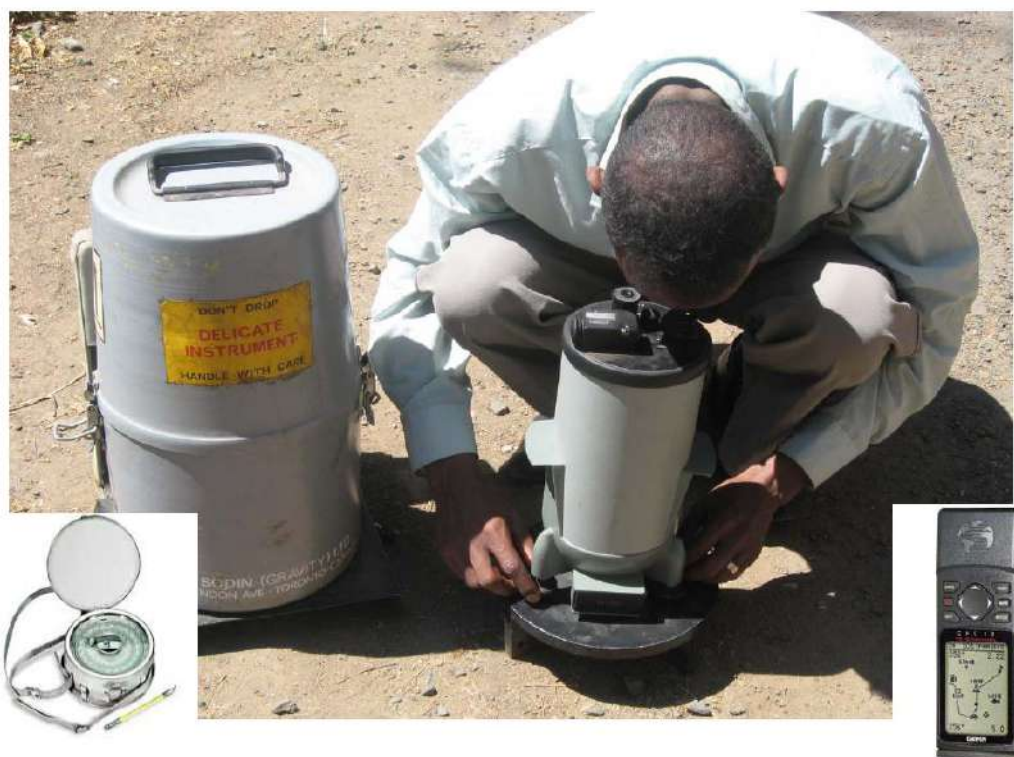
Рис. Измерения с гравиметром Седин. Прибор установлен на подставку, которая обеспечивает уменьшение влияния микросейсм.
