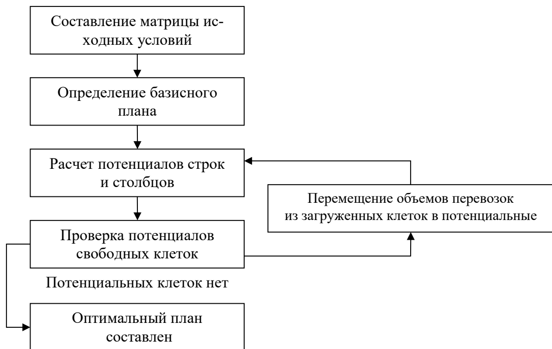
Рис. 4.1. Последовательность решения задач методом потенциалов
