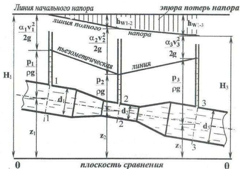
Рис.1.2. Диаграмма уравнения Бернулли для потока вязкой жидкости
