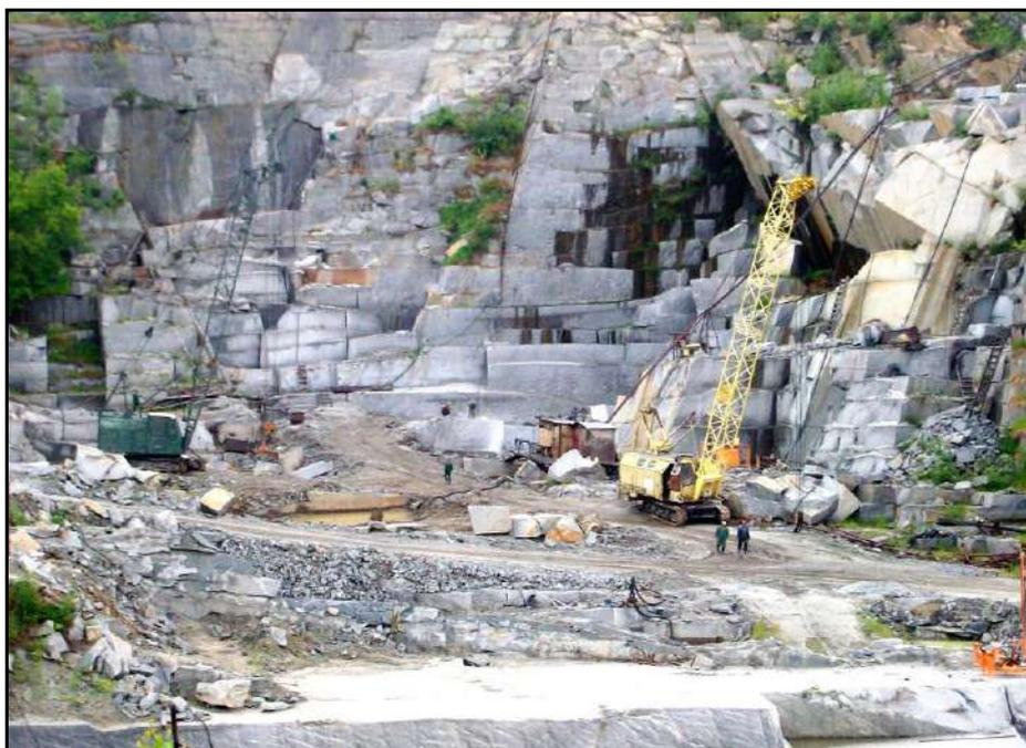
Рис. 22. Сибирский карьер по добыче облицовочных блоков гранитоидов
